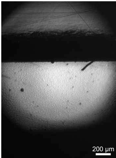
(c) Schliff mit 9 µm-Politur
