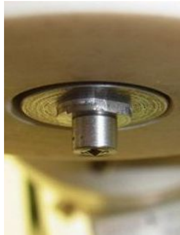
(d) Indenter mit Diamantspitze zur Durchführung von Hochtemperatur-Indentationsexperimenten
