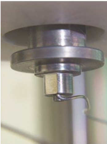
(c) Indentermodell aus TZM zur Validierung der Wegmessung sowie der Indenterheizung
