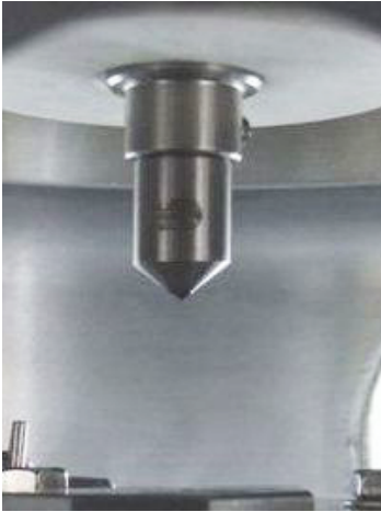
(a) Standard-Rockwell Eindringkörper zur Entwicklung der Prüfvorschrift
