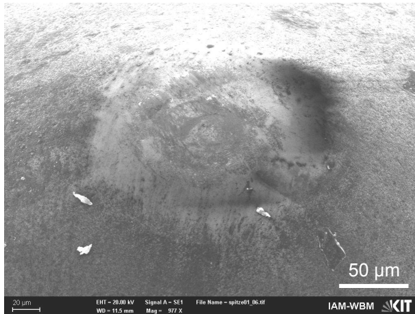
(a) Detailansicht des sphärischen Spitzenbereichs
