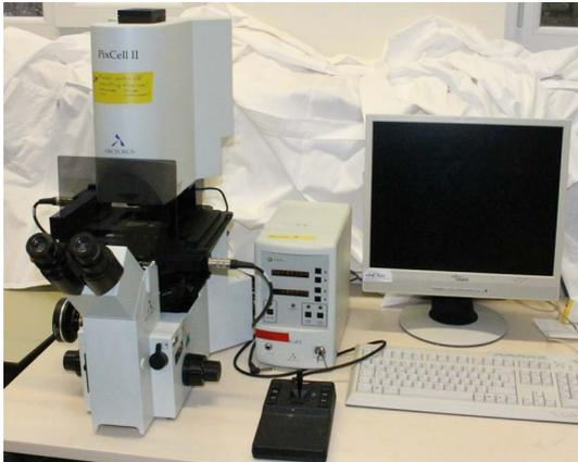
**Abbildung 3.4** Lasermikrodissektionsgerät Pixcell II Laser Capture Microdissection System, Firma Arcturus.
