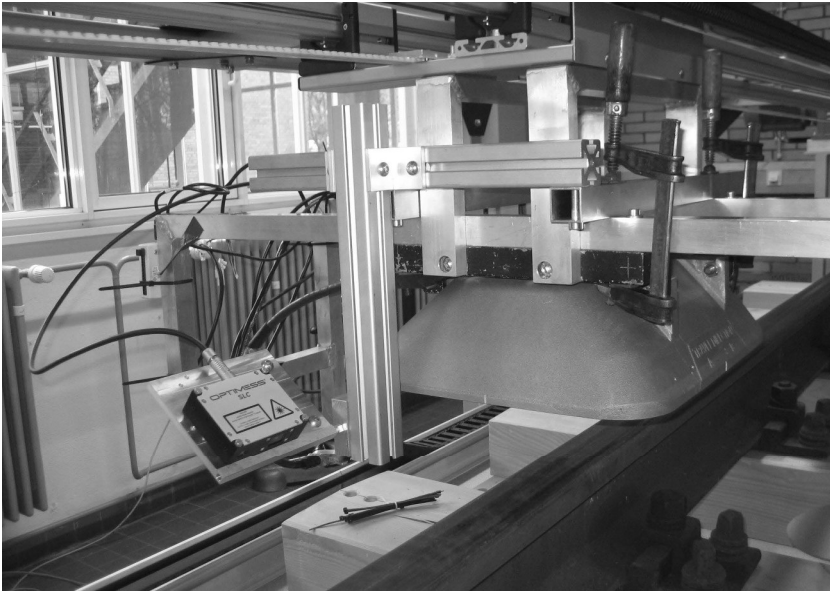
Abb. 2.31: Erprobung des Laser-Distanz-Sensors auf einem Schienenprüfstand [107][68][74]
