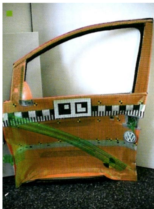
Abbildung A.6: ARVIKA: Augmentierte, gecrashte Fahrzeugtür mit Simulationsdaten [131]
