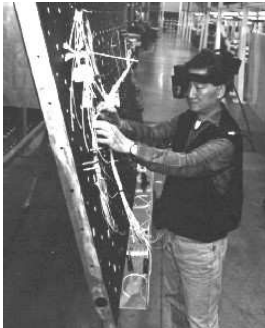
Abbildung 2.20: AR-basierte Herstellung von Kabelbäumen [420]
