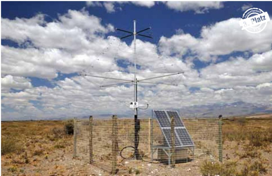
Antenne des Auger Engineering Radio Arrays im Pierre Auger-Observatorium in Argentinien.
