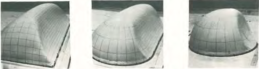
Bild 73 a - c: Traglufthallenmodelle unter Windbelastung
