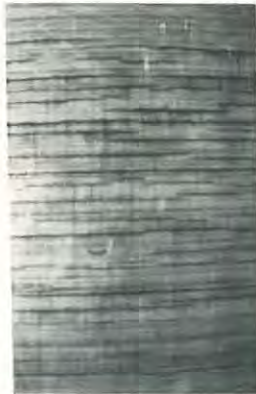
Bild 3: Risse an einem Zylinder-Wickellaminat
