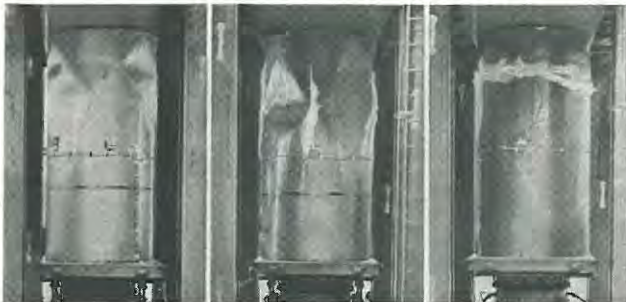
Bild 39 a - c: Die Versuchskörper F 1/2; F 2/6; F 4/8 nach dem Durchschlag
