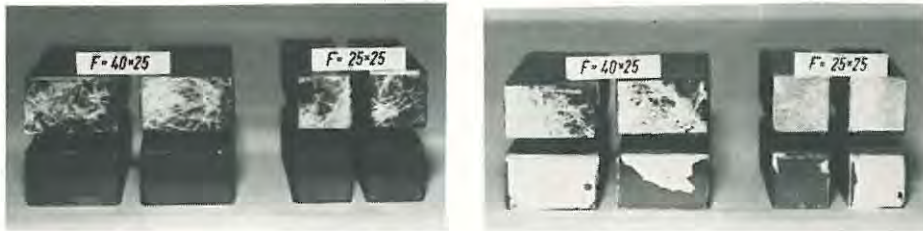
Bild 13 a, 13 b: Bruchflächen der Zugkörper (Vestopal - Araldit)
