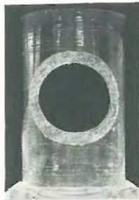
Bild 56: Gebeulte Zylinderschalen mit und ohne Lochrandverstärkung (kreisförmige Öffnung)
