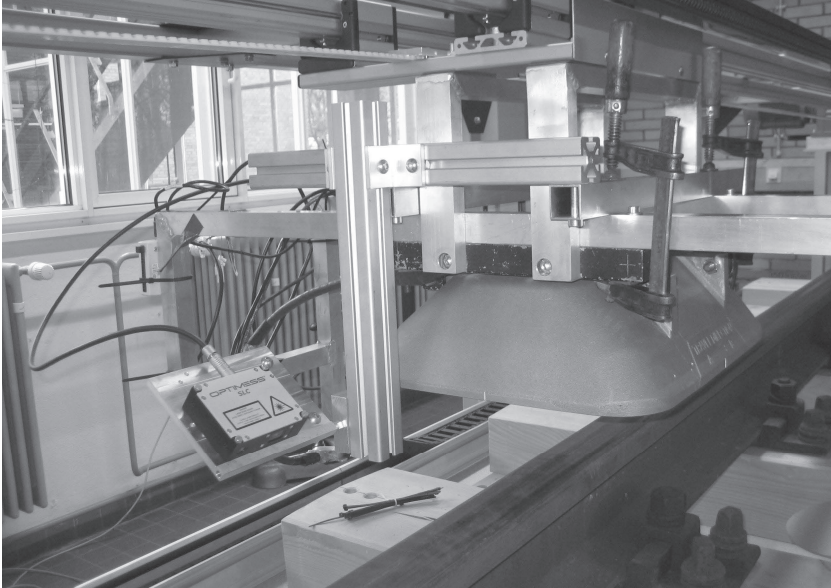
Abb. 2.31: Erprobung des Laser-Distanz-Sensors auf einem Schienenprüfstand [107][68][74]
