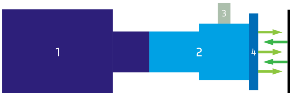
Abbildung 50 Schematischer Aufbau der iRIFS-Messung: Der Aufbau besteht aus einer sCMOS Kamera (1), einem telezentrischen Objektiv (2), einer Hochleistungsdiode (3) und einem \lambda/2 Filter (4). Die Sensoroberfläche (schwarz) wird mit monochromatischem Licht bestrahlt, welches dann von der Kamera detektiert wird. Während der Messung wird der Analyt in Lösung senkrecht zum Lichteinfall durch eine aufgedruckte Silikonkammer (siehe Abdruck in Abbildung 54) gepumpt. (Mit freundlicher Genehmigung der Biametrics GmbH)
