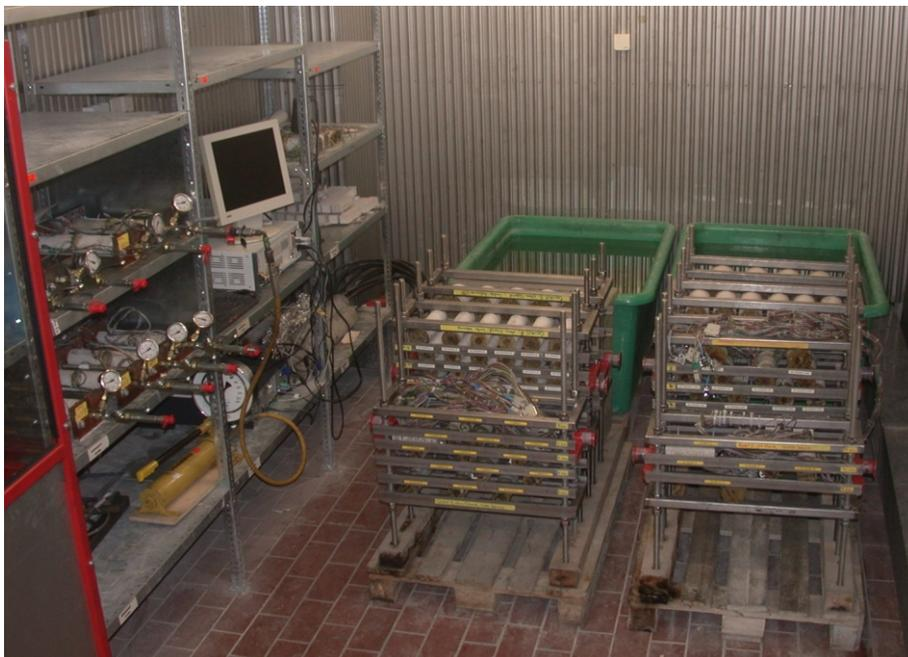
**Abb. A-3** Lager- und Messplatz der Probekörper. Probengestelle mit Korrosionszylindern (rechts im Vordergrund), wassergefüllte Wannen (rechts im Hintergrund), Hohlzylinder mit Stahlrahmen (links) und Messplatz mit Messverstärker und Monitor (links im Hintergrund)
