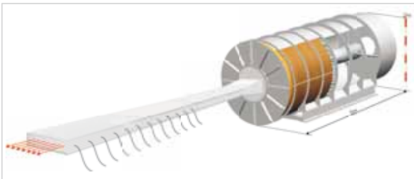
Abb.1: Versuchsstand mit Messstrecke: In einem langen Kanal können definierten Strömungszustände eingestellt werden. Über Druckmessungen entlang des Kanals werden die Energieverluste der Strömung und deren Veränderung durch kleine Modifikationen im Kanalinneren bestimmt.
