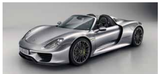
Porsche 918 Spyder: Supersportwagen mit Plug-in-Hybrid-Antrieb und tragender Struktur aus kohlefaserverstärktem Kunststoff
