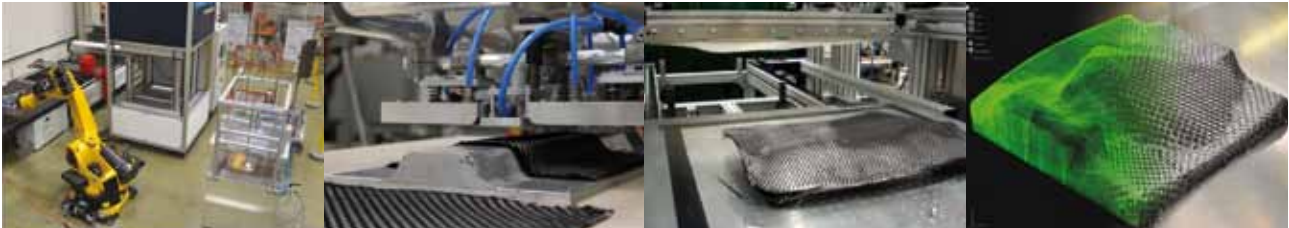
Abbildung 1: (v.l.n.r.) Leichtbauzelle am Institut für Produktionstechnik (wbk), Greif- und Drapiertechnik für textile Halbzeuge, FVK-Textil vor dem Preforming-Prozess, PKW-Stirnwand als komplexes Demonstratorbauteil
