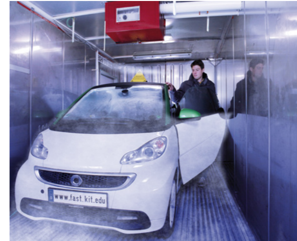
Versuchsfahrzeug im Prüfraum bei Simulation winterlicher Umgebungsbedingungen
