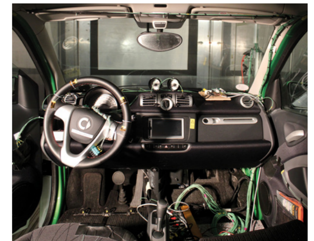
Blick in den mit vielfältiger Sensorik für Temperatur und Luftqualität ausgerüsteten Innenraum des Versuchsfahrzeugs
