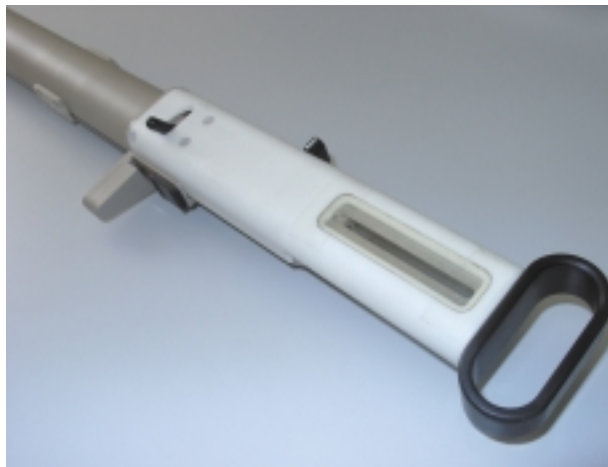
Handsteuereinheit des ROBITOM mit Verschlussmechanismus und Schalter zum Auslösen der Gewebeentnahme
