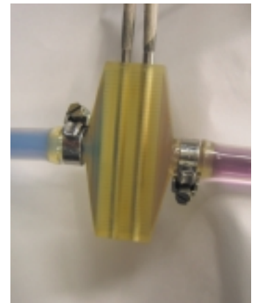
Prototypische Mikrowärmeüberträger aus Kunststoff erlauben das „Zuschauen“ bei einem thermischen Prozess.
