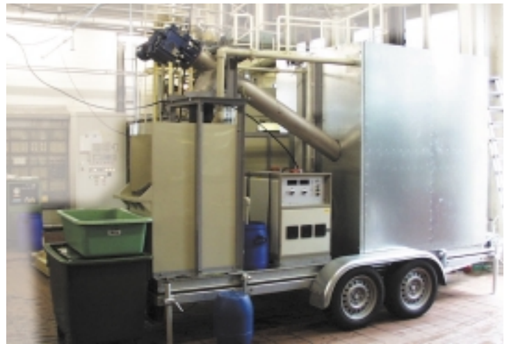
Mobile Elektroporationsanlage KEA zur Maischebehandlung.
