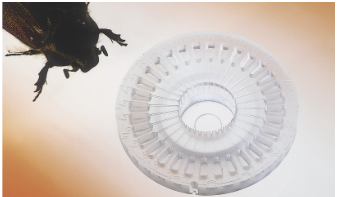
Die BioDisk, das erste von MikroWebFab entwickelte und gefertigte Mikrosystem, kann an einem Blutstropfen 32 Analysen gleichzeitig durchführen.
