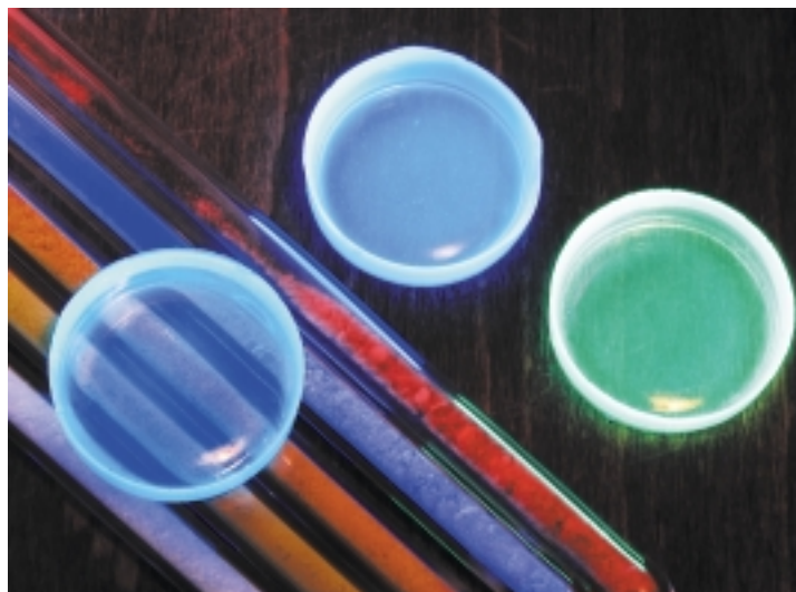
Dreilagige Nanopartikel in Pulverform in Glasküvetten und als Formkörper fluoreszieren im UV-Licht
