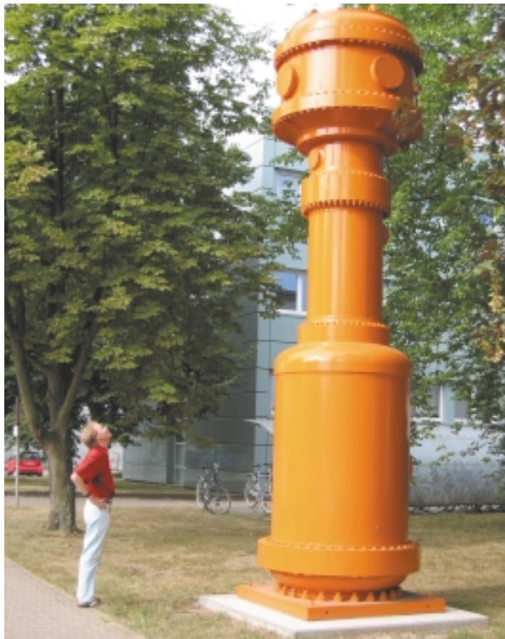
Ehemalige Versuchsanlage IVAN für Sicherheitsexperimente an Reaktordeckeln (vor dem IRS-Gebäude)
