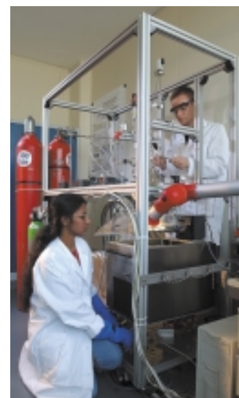
Laboranlage des INT zur Untersuchung der Wasserstoff-Speicher-Eigenschaften von Nanopartikeln
