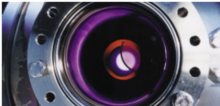
Blick in die ASIDOD-Sputterkammer mit einem 3-Zoll-Substrat, das vor dem Plasma der hinteren Sputterkathode rotiert
