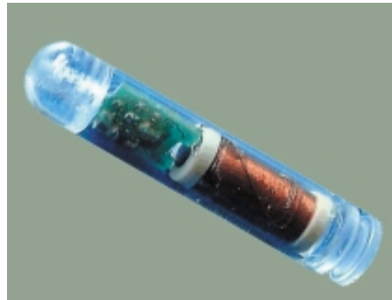
Endosmart BIDS – Miniatursensor zur Messung des Blasenfüllstands
