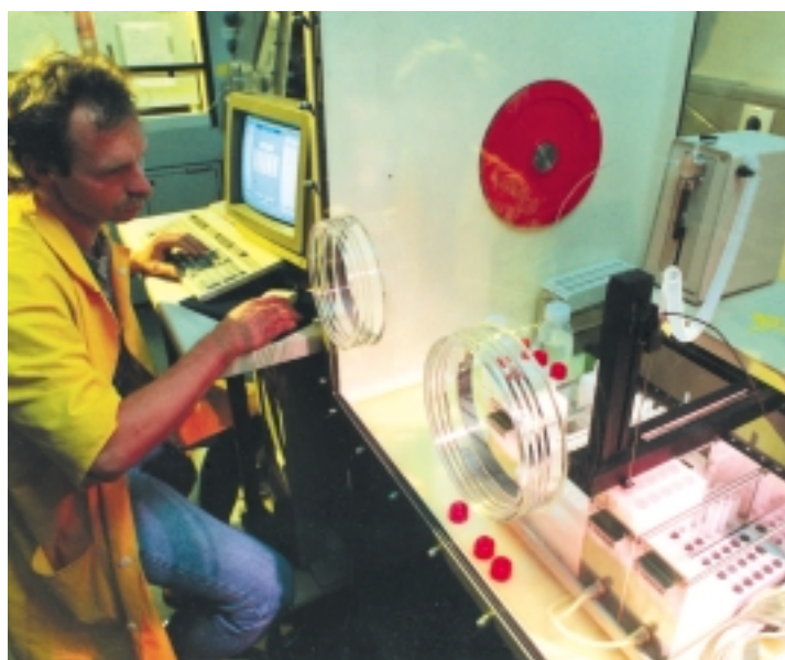
Im Foto ist eine Anordnung zur automatisierten Radionuklidabtrennung mittels Extraktionschromatographie zu sehen.
