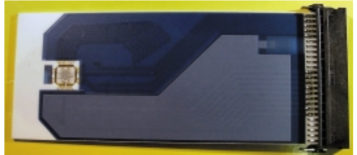
3x3,5mm 2 -grosser KAMINA-Chip mit 16 Gassensorsegmenten (Herzstück der KAMINA)
