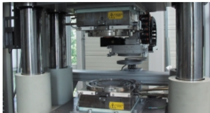
Die Wickert WMP 1000 - Die erste Heißprägemaschine, speziell entwickelt für den Ein-satz in der industriellen Fertigung von Mikrostrukturen.
