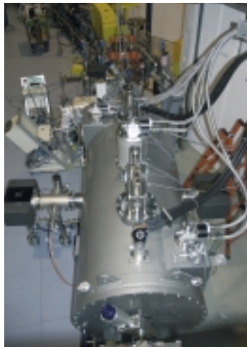
Das in ANKA eingebaute Demonstrationsmodell eines supraleitenden Undulators
