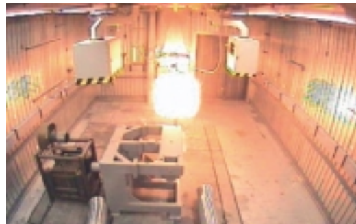
Im Druckbehälter des Wasserstofftechnikums finden Experimente zur Wasserstoffausbreitung und -verbrennung statt
