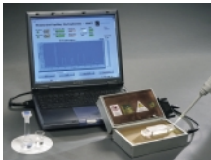
Das Messsystem für die miniaturisierte Kapillarelektrophorese besteht aus einer aufklappbaren Box, die einen auswechselbaren Analysechip, die Messelektronik für die kontaktlose Leitfähigkeitsdetektion und die Elektronik für die Zuführung der Hochspannung zur elektrophoretischen Trennung enthält
