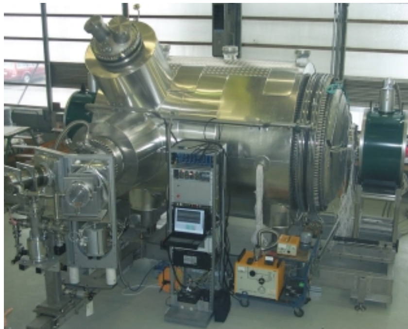
Das Vorspektrometer bietet schon jetzt Raum für erste Tests der eindrucksvollen Apparatur. Die gesamte Anlage wird 70 Meter lang sein, mit einem zehn Meter hohen und 24 Meter langen Ultrahochvakuumtank. Ab dem Jahr 2008 wird das Experiment den Betrieb aufnehmen
