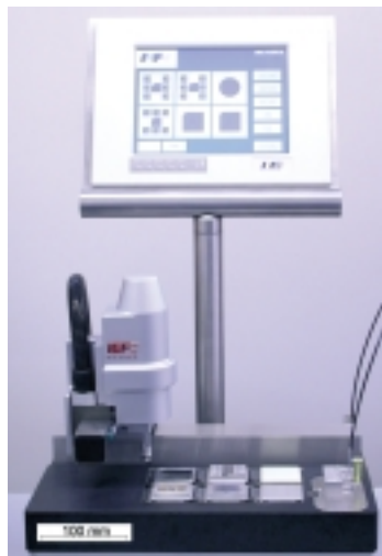
Die von der Firma IEF Werner in Zusammenarbeit mit dem Forschungszentrum Karlsruhe entwickelte Tischfabrik montiert mikrooptische Abstandssensoren
