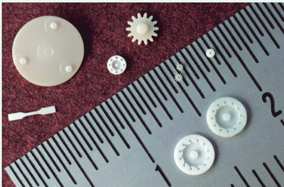
Mikrobauteile aus Zirkonoxid: Die geringsten Durchmesser der Zahnräder liegen bei rund 670 Mikrometern
