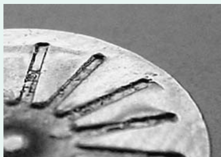
Mit dem neuen Verfahren werden komplex strukturierter Wolframbauteile gefertigt. Das Bild zeigt einen Wärmetauscher, dessen Oberfläche keine Mikrorisse aufweist. Weitere Anwendungen gibt es bei der Oberflächenveredelung und Nachbearbeitung großer komplexer Werkstücke.
