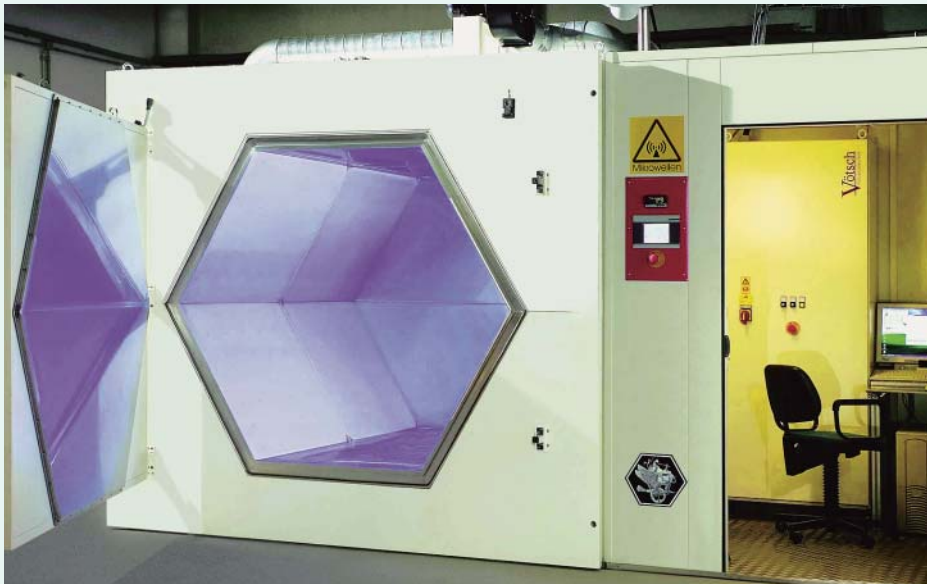
Blick in das Innere der HEPHAISTOS-Großanlage, einem sechseckigen Mikrowellenofen zur Herstellung kohlefaserverstärkter Verbundwerkstoffe.
