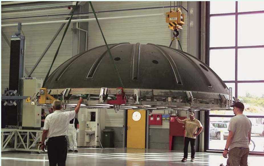
Trotz mehr als sechs Meter im Durchmesser wiegt die A380 Druckkalotte aus kohlefaserverstärktem Kunststoff nur etwa 250 Kilogramm. Foto: EADS
