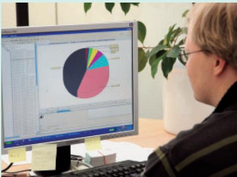
Eintwickler bei der Arbeit mit PALLADIO; das Kuchen-diagramm zeigt, wie stark eine Ressource (z.B. CPU) bei der Bearbeitung von Anfragen ausgelastet ist.
