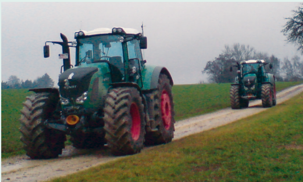
Führtraktor und unbemannter Folgetraktor (vorne im Bild), verbunden durch die elektronische Deichsel.
