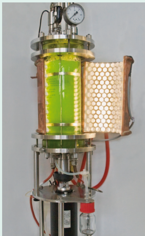
Beleuchtungsmantel an einem Photobioreaktor.
