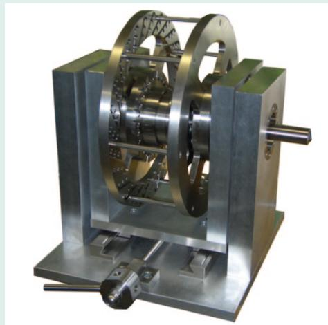
Die Entropiemaschine nutzt Entropieelastizität zur Energiegewinnung.
