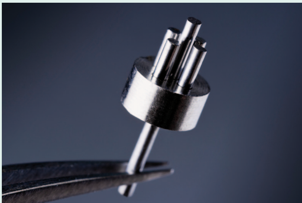
Der Mikroverzahnungsprüfkörper bildet die Merkmale eines Mikrozahnrades prüfsicher ab.
