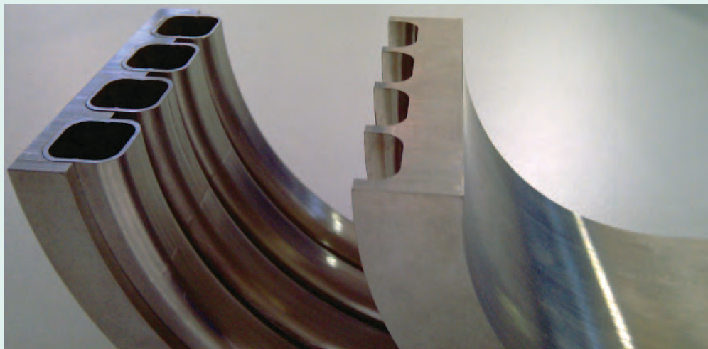
Sicheres Verschweißen von gekrümmten Bauteilen mit Hohlkörperstrukturen.
