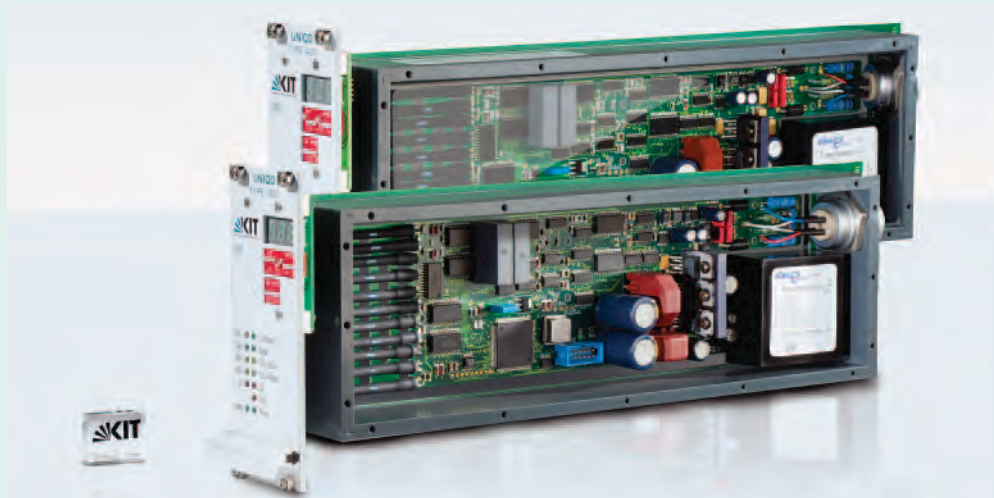
Ein neu entwickelter Quench-Detektor UNIQD vom Typ 3420/3420-HV.
