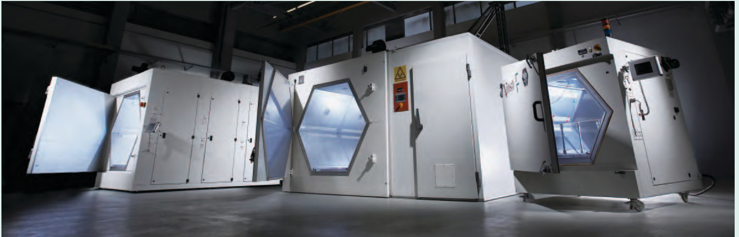
Modular aufgebaute Mikrowellenöfen mit hexagonaler Geometrie.
