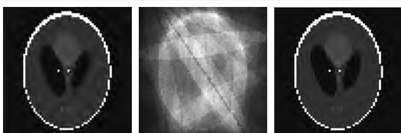
Das Originalbild (links) kann mithilfe des neuen Verfahrens (rechts) deutlich besser rekonstruiert werden als mit einem herkömmlichen Standardverfahren (Mitte).
