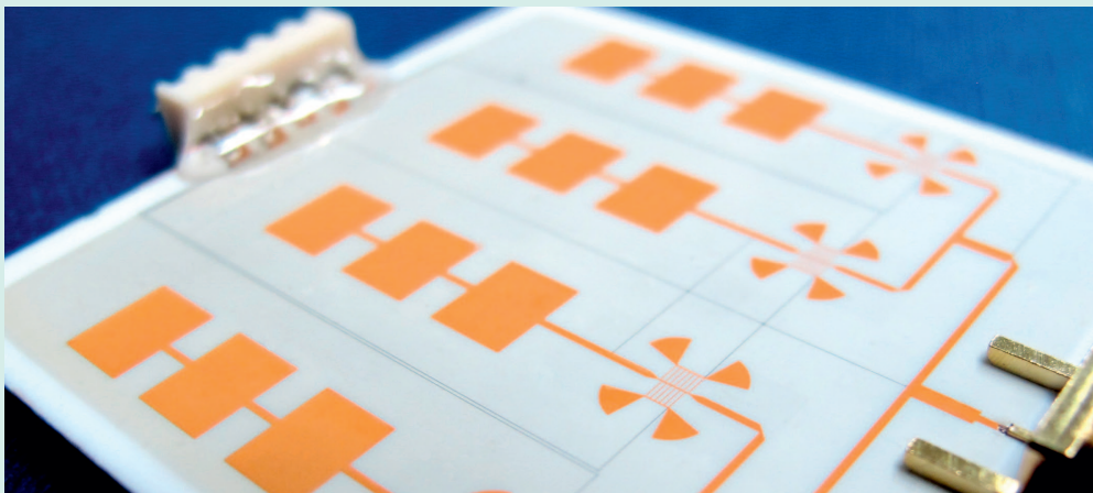
Eine vollständig integrierte Gruppenantenne für elektronische Strahlschwenkung auf einer siebgedruckten BST-Dickschicht.
