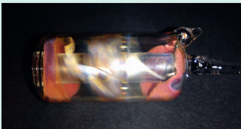
Der Prototyp zeigt die Gasentladungslampe nach dem Betrieb. Im Inneren ist die Vakuumröhre für den Wärmeausgleich zu sehen.
