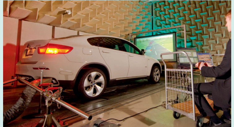
X-in-the-Loop kombiniert reale Versuche auf dem Prüfstand mit Verkehrsfluss-Simulationen. (Foto: bild der wissenschaft)
