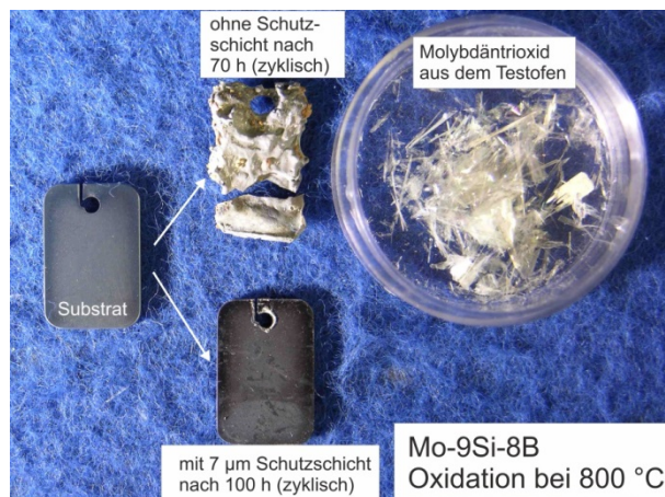
Abbildung 6-1: Dieses Foto zeigt ein Substrat vor der Schichtabscheidung, das verbliebene unbeschichtete Substrat nach 70 h Oxidation bei 800 °C mit \text{MoO}_3 -Nadeln aus dem Ofen und zum Vergleich ein Substrat mit 7 µm dicker Borosilikat-Glas-bildender Oxidationsschutzschicht nach 100 h (10 Zyklen) bei 800 °C.
