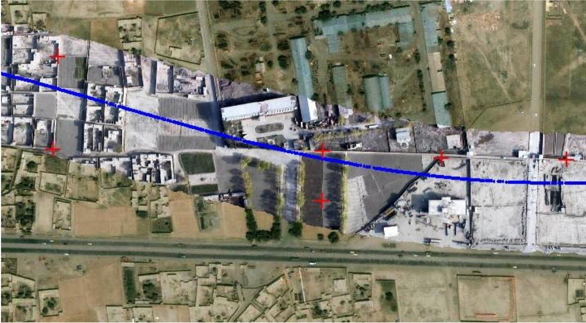
**Abbildung 47: Bildteppich, referenziert mit einem Ikonos-Orthobild (Hintergrund) und in blau eingezeichnetem Flugweg des Sensorträgers (gemäß GPS-Flugdaten). Bild: IOSB, Ikonos-Bild: SGA<sup>21</sup>/Gelsdorf.**
