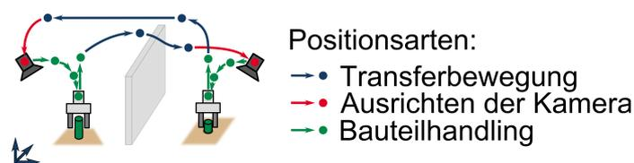
**Abb. 4.13.:** Positionsarten innerhalb eines Pick-and-Place-Ablaufs
