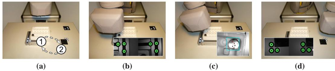
**Abb. 7.11.:** Ablauf der Applikation III „Zylinder lagerichtig zuführen“: a) Überblick über die Einzelschritte. b) Lokalisierung der Zuführpalette über Anschlagwinkel c) Bauteillage erkennen und Greifen. d) Bauteil lagerichtig auf Prozessnest absetzen
