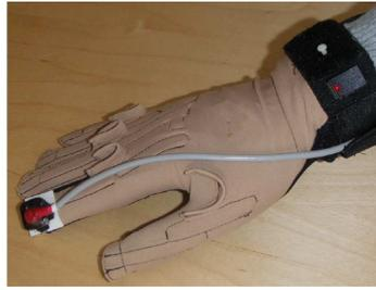
**Abb. 3.7.:** Erfassung der Fingerbewegung über einen lokalisierbaren Handschuh zur Übertragung der Trajektorien auf einen Roboter (aus [Skoglund u. a. 2007])
