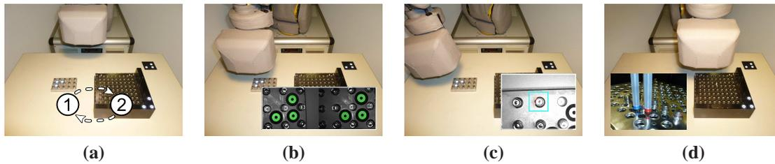
**Abb. 7.9.:** Ablauf der Applikation II „Koppler lagerichtig zuführen“: a) Überblick über die Einzelschritte, b) Lokalisierung der Zuführpalette, c) Bauteillage erkennen und Greifen, d) Bauteil lagerichtig in Palette absetzen
