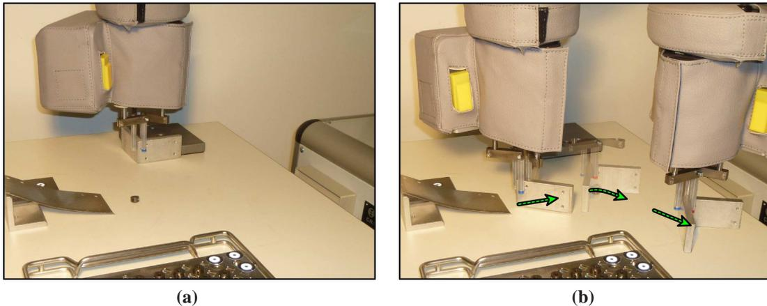
**Abb. 5.10.:** Bauteil mit Hilfe eines Rakels entfernen: a) Rakel greifen, b) Bauteil mit Rakel aus Ablagebereich entfernen
