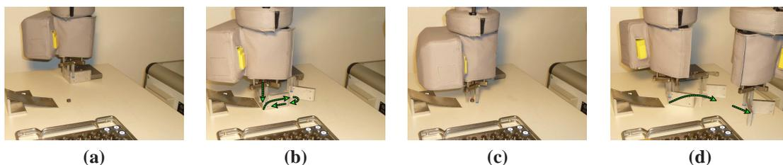
**Abb. 7.15.:** Darstellung der Strategien „Anwesenheitsprüfung“ und „Entfernen“ für Applikation IV: a) Rakel greifen, b) Zentrierbewegung zur Positionierung des Bauteils, c) Anwesenheitstest per Griff, d) Bauteil mit Rakel entfernen
