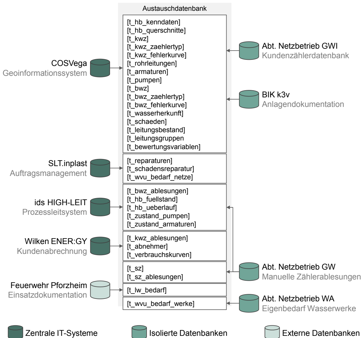
Abbildung 6.10: Erstellung der Austauschdatenbank über Sichten auf IT-Systeme, isolierte und externe Datenbanken
