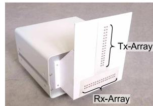
(b) Radarsystem im Gehäuse mit Antennen
