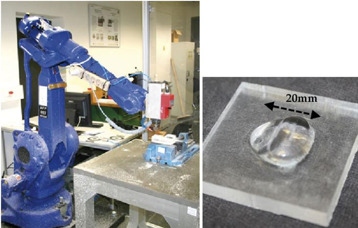
**Abbildung 7.34:** Foto des zur Fertigung eingesetzten Fräsroboters der Fachhochschule Aalen (links) und der hergestellten Freiform-Linse zur Straßenbeleuchtung (rechts).
