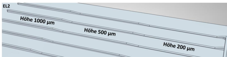
Abbildung 6-2: Detaillierte Darstellung des zweiten Einlasskanals (EL2) aus Abbildung 6-1, in dem die P-MEP durchgeführt wurde. Der Kanal variiert in der Höhe zu 1000, 500 bzw. 200 \mu\text{m} .
