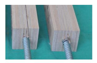
Abb. 11 Reihe 3: Versagensformen der maßgebenden Verbindung
