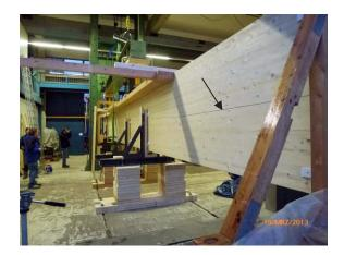
Abb. 33 Schubversagen im unverstärkten Hauptträger
