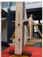
Abb. 34 Schubversagen beim verstärkten Hauptträger
