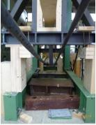
Abb. 35 Versagen an der Stahlplatte und seitliches Ausweichen der Spreizpfosten
