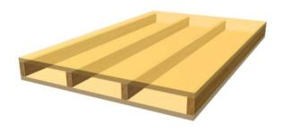
Abb. 7 Schubfest verklebtes Kastenelement
