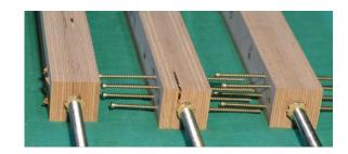
Abb. 14 Versagensformen der maßgebenden Verbindungen der Versuchsreihe mit Querlagen und mit Querzugverstärkung
