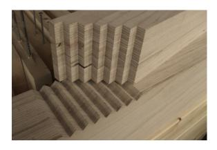
Abb. 3 Ergebnis Abbund eines Treppenversatzes
