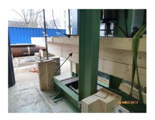
Abb. 36 Schubversagen beim unverstärkten Nebenträger
