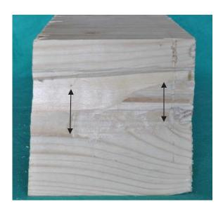
Abb. 30 Partielle Verklebung in den Fugen
