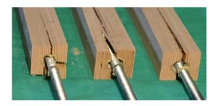
Abb. 13 Versagensformen der maßgebenden Verbindungen der Versuchsreihe ohne Querlagen und ohne Verstärkung
