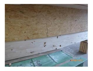
Abb. 37 Nebenträger mit Biegezugversagen unterhalb der Lasteinleitungsstelle
