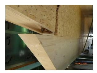
Abb. 38 Nebenträger mit Biegezugversagen am Ende der Zuglasche
