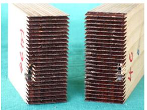
Abb. 17 Für Zugfestigkeiten ab 55 N/mm² sind ordnungsgemäß gefräste und verklebte Zinken unabdingbar (oben), Negativbeispiel (unten)
