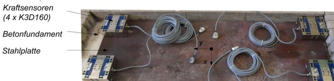
**Abb. 5.6:** Anordnung der Kraftsensoren auf dem Betonfundament
