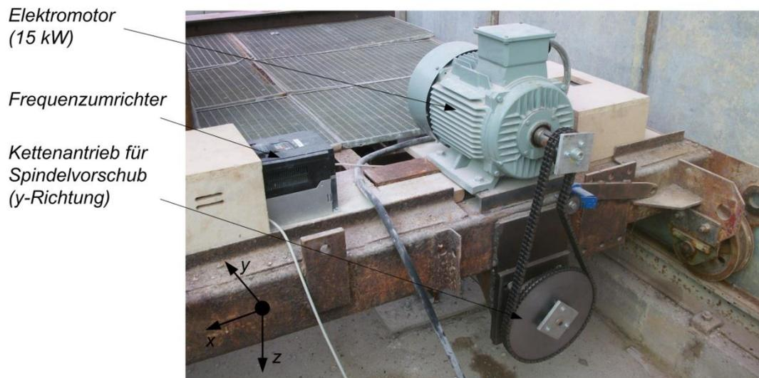
**Abb. 5.3:** Ausschnitt der Führungstraverse mit Kettenantrieb
