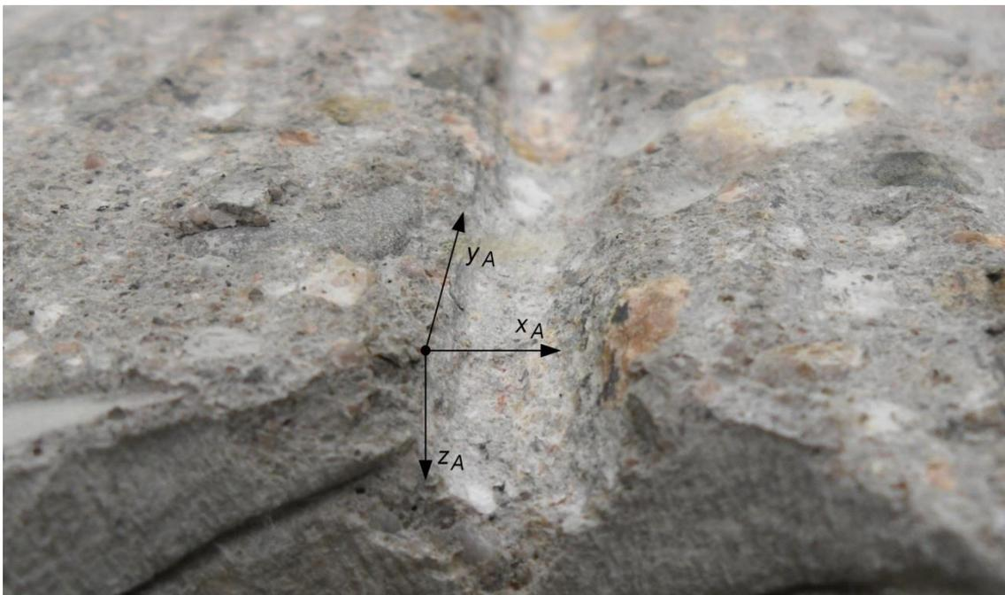
**Abb. 6.12:** Bildung von Fugen bei der Betonbearbeitung durch Hartmetalllamellen
