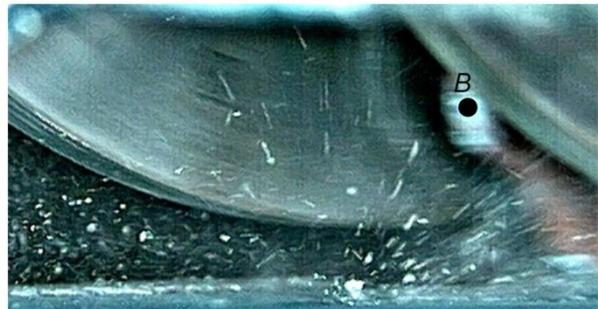
**Abb. 4.11:** Aufnahme des Schlagvorganges einer Hartmetalllamelle mit Hochgeschwindigkeitskamera
