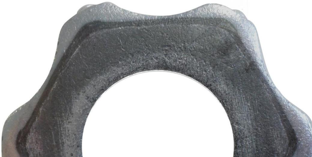
**Abb. 6.23:** Vergleich der Lamellengeometrie für  $s_L = 0 \text{ m}$  (helle Darstellung) und  $s_L = 540 \text{ m}$
