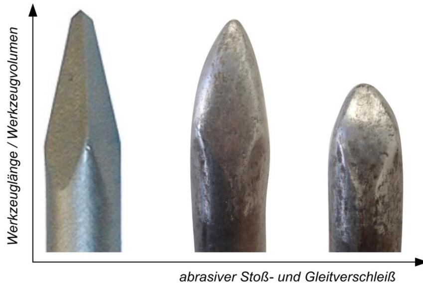
**Abb. 3.13:** Abrasive Verschleißentwicklung beim Spitzmeißel
