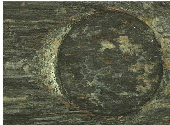
**Abb. C.3:** Übergang der Flankenfläche zur Hartmetallspitze mit zunehmendem Verschleiß
