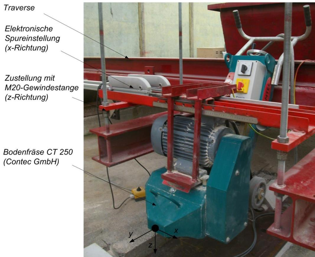
**Abb. 5.2:** Führungssystem der Bodenfräse CT 250 am Versuchsstand
