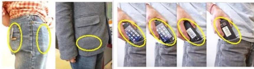
Abb. 8. Verschiedene Orientierungen des Smartphones, wie sie bei unterschiedlichen Benutzern auftreten können. Durch Berücksichtigung der Orientierungen verbessert sich die Klassifikation (siehe: [13]).
