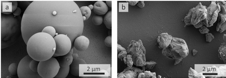
Abbildung 3.1 Geometrie der Aminosäurepartikel. a) Mit dem Sprühtrockner hergestellte Partikel, b) Partikel aus der Luftstrahlmühle. [23]
