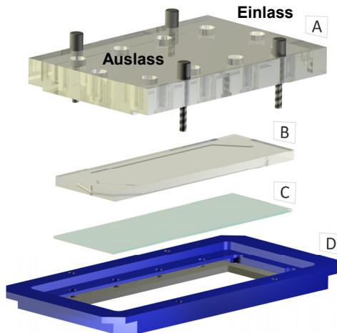
Abbildung 6.4 MicCell-System, bestehend aus einem Deckel (A) aus Polycarbonat, dem Fluidikkanal aus PDMS (B), auf dem der Peptidmicroarray (C) über Schrauben und einen Gegenhalter (D) anpresst und somit abdichtet wird. (nach [78])
