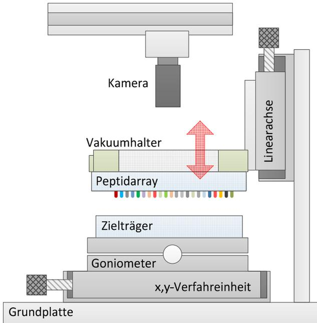
Abbildung 5.8 Skizze des Funktionsprinzips des positionsgesteuerten Übertrags.
