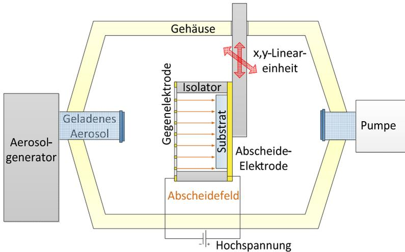
Abbildung 3.10 Skizze der entwickelten Beschichtungsanlage.
