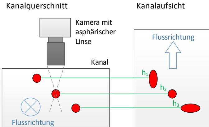
Abbildung 6.5 Messprinzip von  $\mu$ APTV. Die Partikelgeometrie ändert sich mit der z-Position der Partikel im Kanal. Dadurch kann mit einer 2-dimensionalen Aufnahme in der Kanalaufsicht die Geschwindigkeit in Abhängigkeit von der Höhenposition der Partikel berechnet werden.
