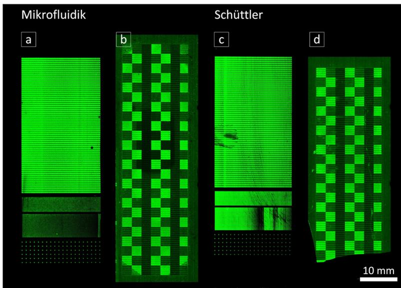
Abbildung 6.14 Fluoreszenzbild der inkubierten Arrays. Dabei wurde in der mikrofluidischen Kammer a) ein Biotin-Array und in b) ein FLAG-Peptidarray inkubiert. Die Inkubation eines c) Biotin-Arrays und d) eines Peptidarrays erfolgte mit der Standardmethode auf dem Schüttler. b) – d) wurden mit der gleichen Intensität gescannt, bei a) wurde die Intensität verringert, um den Kontrast zu erhöhen.
