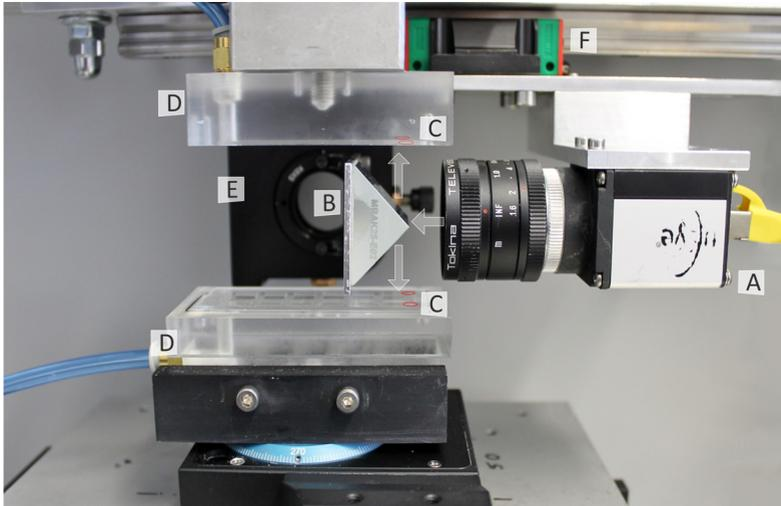
Abbildung 5.11 Positionierung mit einem Knife-Edge-Prisma der Maschine 2 Mit der Kamera (A) lassen sich über das Prisma (B) Markierungen (C) auf den beiden Oberflächen aufnehmen, die im Vakuumhalter montiert sind. Das Prisma ist über einen Prismenhalter (E) justierbar. Das Positioniermodul wird zum Positionieren manuell zwischen die beiden eingespannten Träger über einer Linearführung (F) bewegt.
