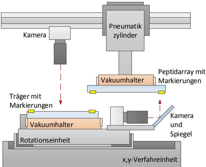
Abbildung 5.7 Konzept der Positionierung mittels zweier Kameras. Mit der stationären Kamera und einer mit dem unteren Substrat mitbewegten Kamera werden die Markierungen des Zielträgers und des Peptidarrays aufgenommen. Aus den Positionsdaten lassen sich die notwendigen Koordinaten des Zielträgers berechnen und dieser wird dann mit der Verfahrenheit entsprechend positioniert.
