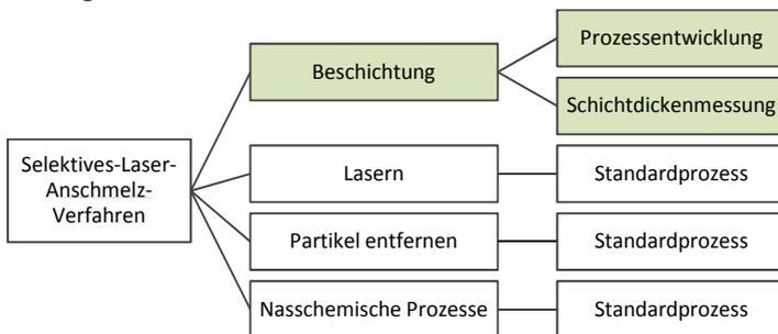
Abbildung 4.1 Einteilung des Selektiven Laser-Anschmelz-Verfahrens in Einzelprozesse.
