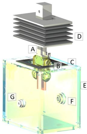
Abbildung 3.12 CAD-Studie zum Dichtungskonzept [40]. Der Greifer mit dem Substrat (A) wird in einem Faltenbalg (D) geführt, der die Bewegung abdichtet. Für die Beschichtung wird dieses Modul auf einer Dichtung (C) mit Elektromagneten (B) fixiert, sodass keine Partikel aus der Beschichtungskammer (E) mit dem Aerosoleinlass (G) und -auslass (F) austreten können.
