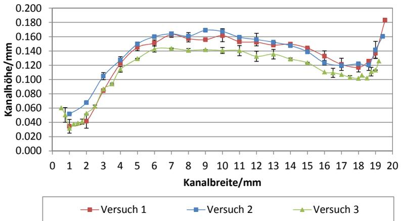
Abbildung 6.11 Höhe des Kanals. Der Kanal wurde in drei Versuchen neu montiert und die Höhe wurde mit dem Mikroskop über die Fokusslage vermessen.
