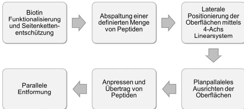
Abbildung 5.5 Ablauf des neu entwickelten Prozesses.
