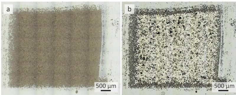
Abbildung 3.15 Bestimmung der Porosität. a) Mit der Anlage aufgebraachte Partikelschicht. b) Partikelschicht nach dem Schmelzvorgang.
