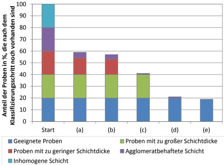
Abbildung 4.4 Anteil der Proben, die nach den Klassifizierungsschritten a-e noch vorhanden sind. Die unbrauchbaren Proben werden nach mehreren Klassifizierungszyklen aussortiert, ausschließlich gute Proben bleiben in der Produktion.
