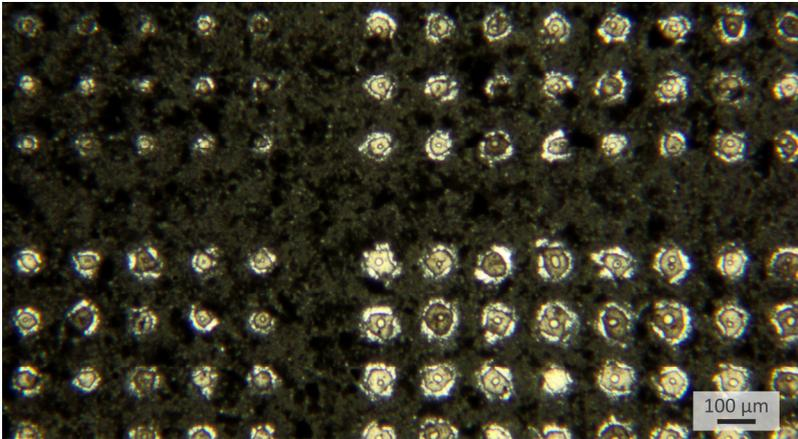
Abbildung 3.16 Mikroskopaufnahme einer Partikelschicht für die Messung des Äquivalenzdurchmessers der Spots in Abhängigkeit von der Laserleistung.
