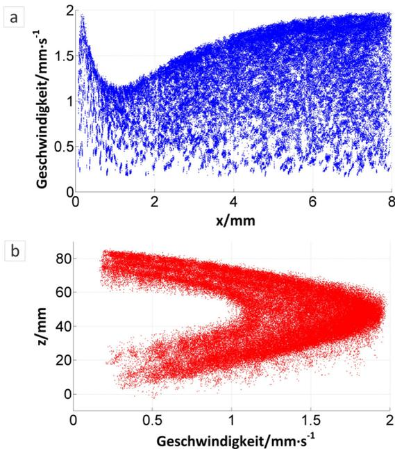
Abbildung 6.10 Messung der Geschwindigkeitsprofile im Kanal an der Stelle E. a) zeigt die Verteilung quer zur Strömungsrichtung entlang des halben Kanalquerschnittes. b) stellt die Verteilung der Geschwindigkeit in der Höhe entlang der Strömungsrichtung dar.
