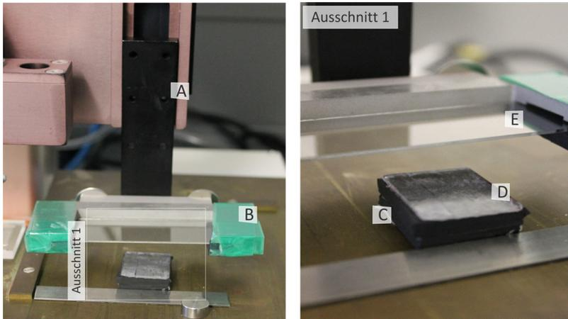
Abbildung 5.4 Vorversuche zum Übertrag mit dem Tischroboter Janome 2200 mini. Die Linearachse (A) des Tischroboters fährt die Halterung (B) und den darin eingespannten Peptidmicroarray (E) auf die Zieloberfläche (D), die auf einer viskoelastischen Unterlage (C) fixiert ist.
