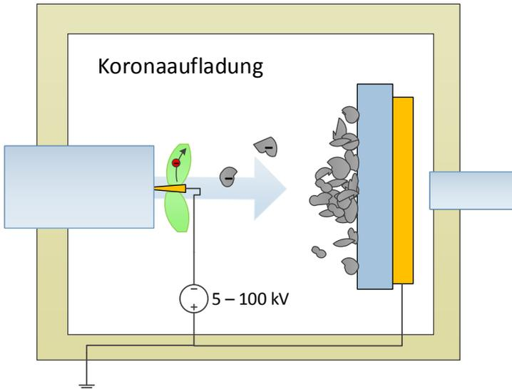
Abbildung B.2 Aufbau zur Korona-Aufladung der Partikel
