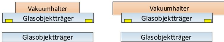
Abbildung 5.16 Vergleich der Auflagefläche der Halterung des Objektträgers.
