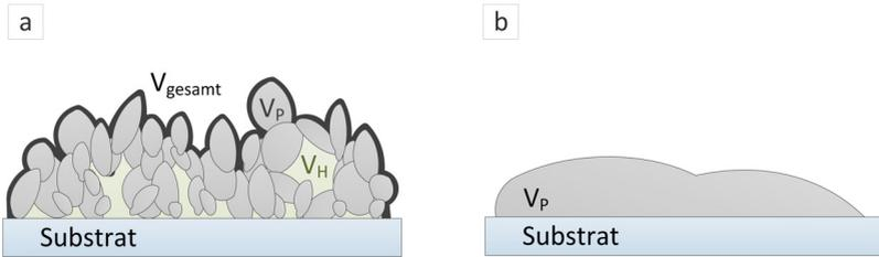
Abbildung 3.14 Vorgehensweise zur Bestimmung der Porosität. a) Das Gesamtvolumen der Partikelschicht besteht aus dem Volumen der Partikel und dem Hohlraumvolumen. b) Nach dem Schmelzvorgang entspricht das Gesamtvolumen dem des Partikelvolumens.
