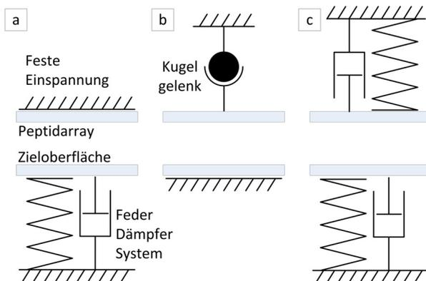
Abbildung 5.3 Ideensammlung zum passiven planparallelen Ausrichten und Entformen: (a) Array fest eingespannt, Zieloberfläche mit parallelem Feder-, Dämpfersystem. (b) Kugelgelenk in Kombination mit fester Einspannung. (c) Kombination aus zwei Feder-, Dämpfersystemen.
