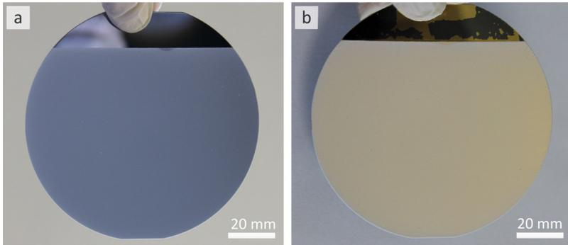
Abbildung 3.25 Beschichtung eines 4-Zoll (a) Si-Wafers und (b) Gold beschichteter Si-Wafer mit  $\text{TiO}_2$ -Partikeln [31].
