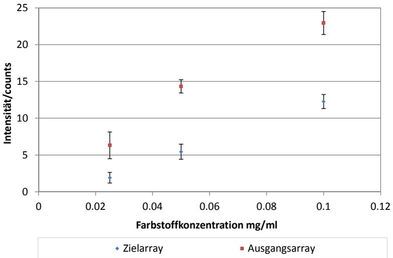
Abbildung 5.24 Intensität des Fluoreszenzsignals zur Bestimmung der Transferrate für den Übertrag DropletMicroarray auf DropletMicroarray.
