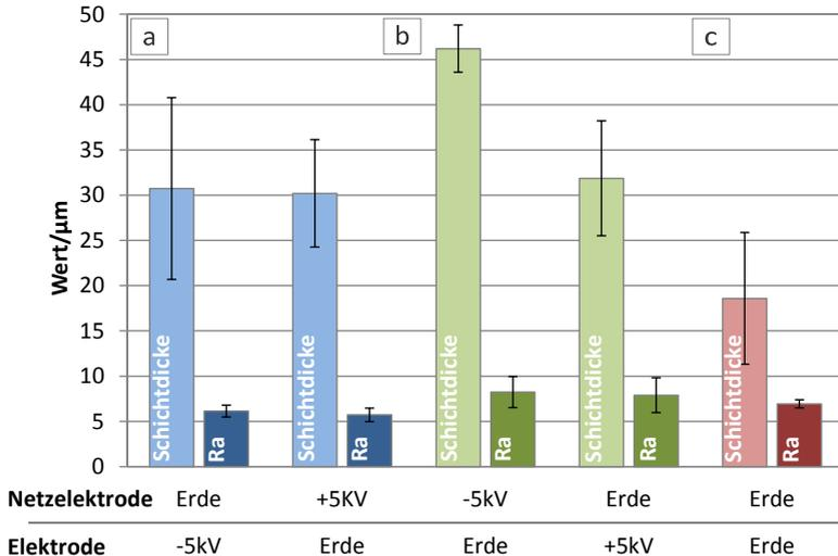
Abbildung 3.19 Einfluss der Feldrichtung auf die Schichtdicke und den Mittenrauwert Ra. Die Richtung des elektrischen Feldes zwischen Netz- und Abscheideelektrode wurde variiert. a) positive Feldrichtung b) negative Feldrichtung, c) zeigt die Werte ohne Feld. Beschichtungsparameter entsprechend B.2 (nach [31]).
