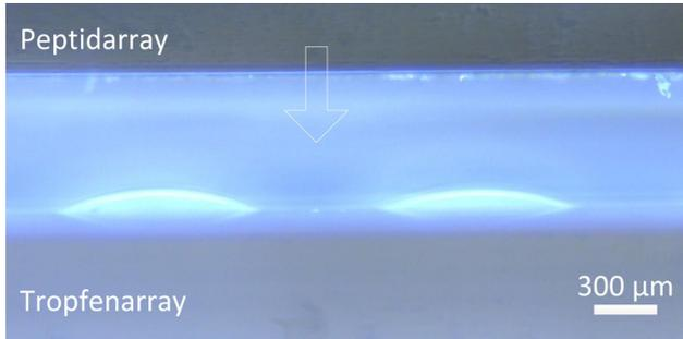
Abbildung 5.15 Frontansicht für die vertikale Positionierung des Peptidarrays und des Droplet-Microarrays. Der Peptidarray wird so positioniert, dass die Oberfläche die Tropfen berührt und der Übertrag durch Diffusion stattfindet.
