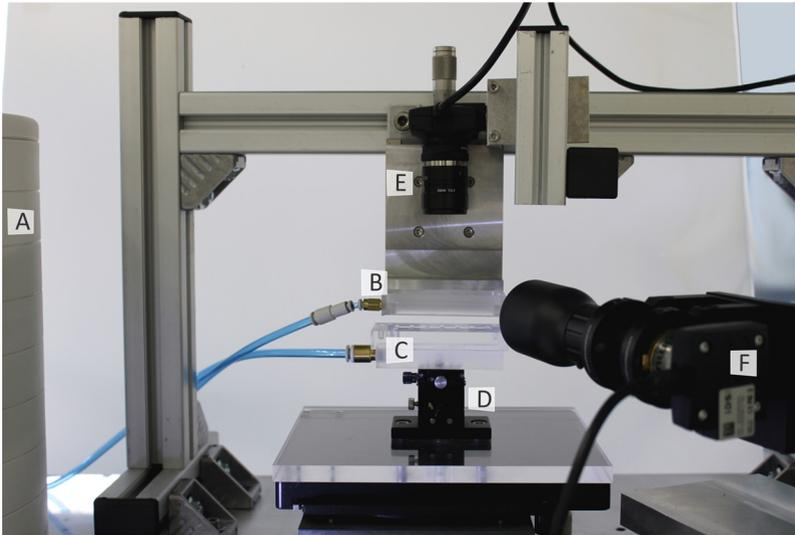
Abbildung 5.14 Maschine 3 für den positionsgesteuerten Übertrag. Der Luftbefeuchter (A) sorgt für eine geeignete Transferumgebung. Der Array wird in den Vakuumschalter (B) eingespannt, der Zielträger wird in den unteren Halter (C) eingespannt und mit Goniometer (D) planparallel ausgerichtet. Die Positionierung für den Übertrag erfolgt über einen Lineartisch (E) und wird mit einer Kamera (F) überwacht.
