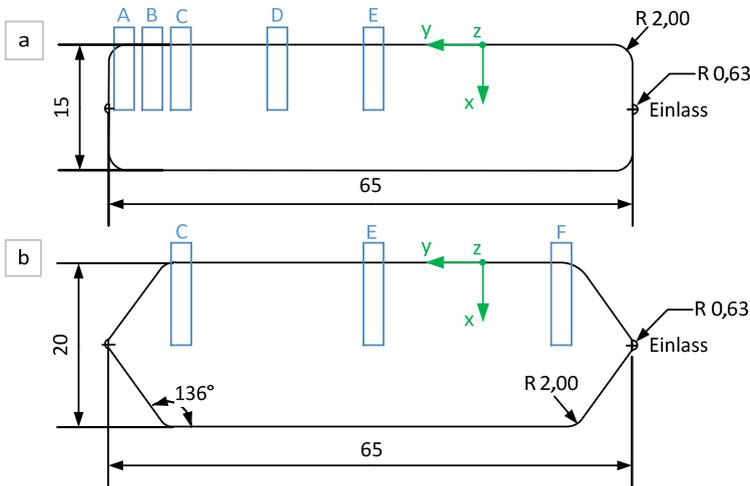
Abbildung 6.7 Draufsicht der verwendeten Kanäle. a) Flächenoptimierter Kanal, bei dem die rechteckige Geometrie möglichst viel Peptidarrayoberfläche abdeckt. b) Strömungsoptimierter Kanal. Die Geschwindigkeitsverteilung wurde an den Positionen A – F und C – F entlang der Koordinate x gemessen. Die Maße sind in mm angegeben.
