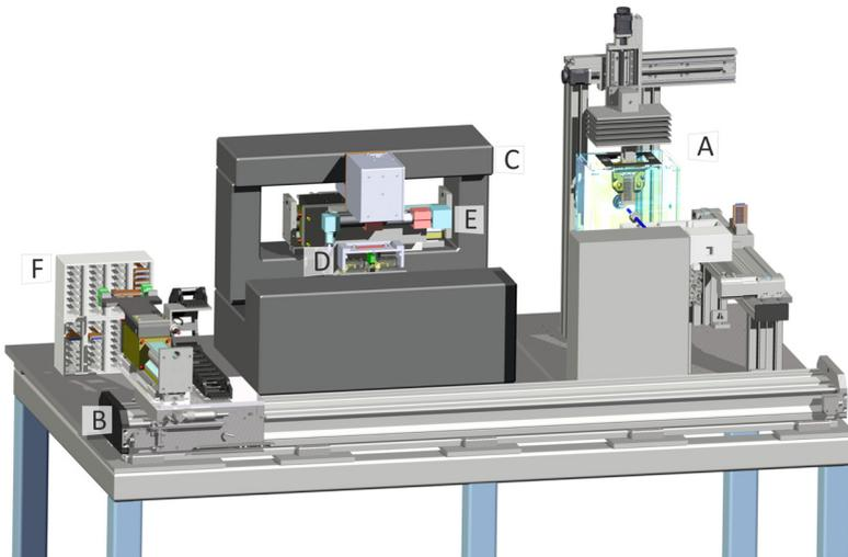
Abbildung 4.5 Konzept der Automatisierung. Nach der Beschichtung der Glassubstrate (A), die in einen Träger eingelegt sind, wird dieser mit der Linearachse (B) und einem Greifer zur Lasereinheit (C) gefahren und dort in eine Ablage (D) positioniert. Mit der Kamera (E) lässt sich die Position anhand von Markierungen bestimmen. Die Träger können in einem Depot (F) zwischengelagert werden.
