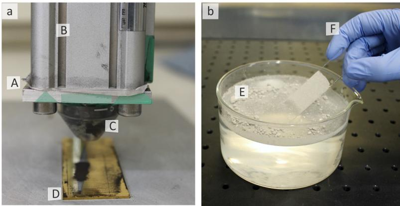
Abbildung 3.4 Pneumatik-Zylinder und Variation der Langmuir-Blodgett-Methode. a) In einem Pneumatikzylinder (B) werden Partikel auf das Substrat (D) mit Hilfe einer Düse (C) beschleunigt. Agglomerate werden über ein Netz (A) gefiltert. b) Eine Partikellage setzt sich in einem Becherglas mit deionisiertem Wasser auf der Oberfläche ab und wird durch Eintauchen eines Glasobjektträgers (F) auf diesem abgeschieden.
