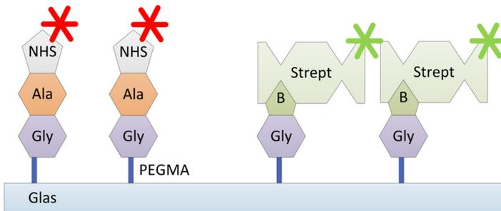
Abbildung 3.17 Schemata der Peptidsynthese Das Glycin (Gly) wird nach der Strukturierung der Glycinpartikelschicht an die amino-funktionalisierte Oberfläche (PEGMA) gekuppelt. In weiteren Kupplungsschritten werden dann Alanin (Ala) und Biotin (B) gekuppelt. Der Erfolg der Synthese wird durch die Bindung von fluoreszenzmarkierten Molekülen (NHS Ester und Streptavidin) nachgewiesen.
