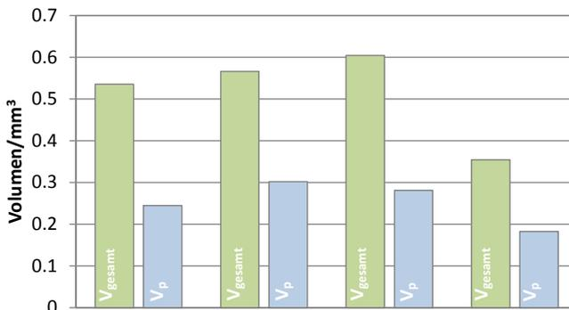
Abbildung 3.22 Vermessung von Partikelschichtvolumina mit unterschiedlicher Ausgangsschichtdicken vor ( $V_{\text{gesamt}}$ ) und nach dem Schmelzvorgang ( $V_p$ ) zur Bestimmung der Porosität von Partikelschichten mit Luftstrahlmühlenteilchen.
