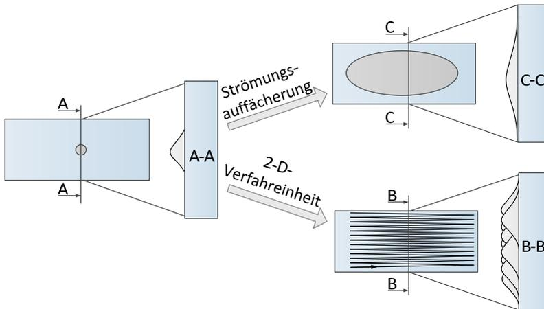
Abbildung 3.8 Konzept der Abscheidung der Partikel auf großer Fläche. Der Aerosolspot kann aufgefächert werden, oder mittels einer Verfahrenheit über das Substrat bewegt werden.
