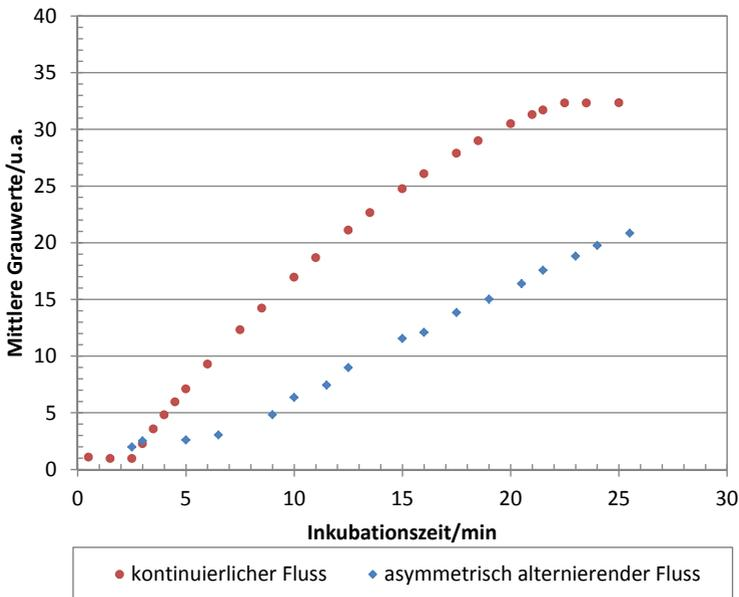
Abbildung 6.13: Mittlere Grauwerte über die Inkubationszeit zweier mit fluoreszenzmarkierten Streptavidin-inkubierten Biotin-Oberflächen. [82]
