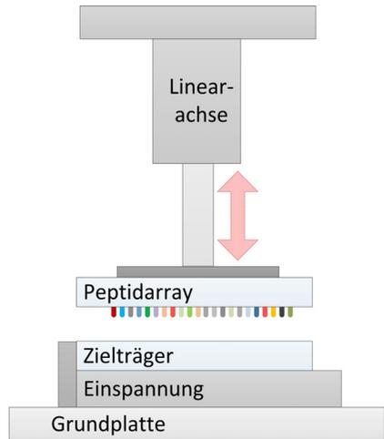
Abbildung 5.6 Skizze der entwickelten Anlage
