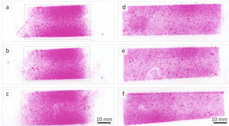
Abbildung 5.17 Verteilung des Anpressdrucks bei Maschine 1. a) - c) zeigen die Druckverteilung bei dem Vakuumhalter mit einer Fläche von 50 mm × 26 mm. Ein vollflächiger Kontakt der Glasträger konnte nicht erreicht werden. In d) - f) wurde ein Vakuumhalter mit einer Fläche von 80 mm × 26 mm verwendet. Beide Träger kommen mit ihrer gesamten Fläche in Kontakt.
