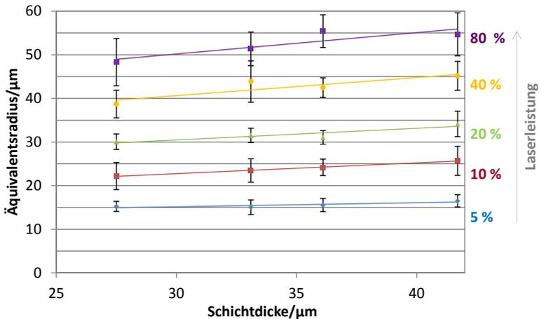
Abbildung 3.23 Einfluss der Laserleistung auf den Äquivalentsradius der Spots in Abhängigkeit zur Höhe der Schicht Die Laserleistung wurde in Schritten von 5 % bis 80 % variiert.
