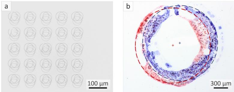
Abbildung 5.19 Bestimmung der Positioniergenauigkeit. a) Mit dem eingebauten Mikroskop wurde die Verschiebung von Markierungen vor und nach dem Prozess überlagert. Die Positioniergenauigkeit wurde über die Verschiebung der Mittelpunkte bestimmt. b) Mit einem Stempel wurden zwei Tinten auf den gleichen Träger übertragen und die gedruckten Muster mit einem Mikroskop vermessen.
