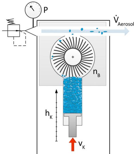
Abbildung 3.7 Schematischer Aufbau und Funktionsweise des Bürstendispersierers.  $v_K$  bezeichnet den Kolbenvorschub,  $h_K$  die Position des Kolbens im Zylinder,  $n_B$  die Umdrehungsgeschwindigkeit der Bürste,  $P$  den an den Aerosolgenerator angelegten Druck der Druckluft und  $\dot{V}_{\text{aerosol}}$  den Aerosolvolumenstrom
