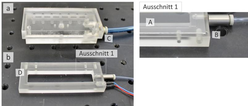
Abbildung 5.10 Eigenentwicklung des Sauggreifers. a) Unterer Vakuumhalter, b) Vakuumhalter mit Aussparung zur Positionierung. Der Glasobjektträger (A) liegt auf einer PDMS-Dichtung auf und kann über Positionsstifte oder Anschläge (B) mechanisch vorpositioniert werden. Das Vakuum wird über eine Bohrung (C) angelegt. Über Passstifte und Bohrungen (D) wird der Halter an die Anlage montiert.
