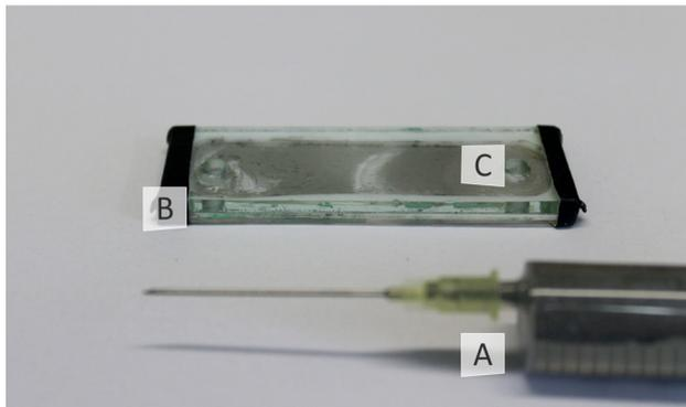
Abbildung 3.3 Mikrofluidik für die Handhabung von Partikeln. Die Partikeln, dispergiert in flüssigen Medien (A) werden in eine mikrofluidische Kammer (B) gespritzt und bilden nach dem Sedimentieren eine Partikelschicht aus (C).
