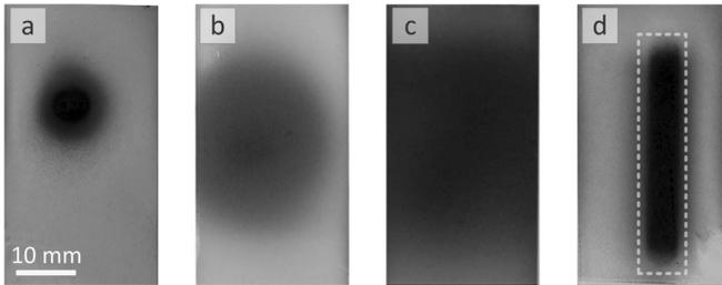
Abbildung 3.9 Vorversuche zur Beschichtung. a) Beschichtung aus dem Freistrahlsystem mit einer gaußförmigen Schichtdickenverteilung. b) Verbreiterung des Aerosolstromes mit einem Sieb mit einer Maschenweite von 35 µm. c) Verbreiterung des Aerosolstromes mit einer Kugel. d) Beschichtungsprozess mit einer x,y-Verfahreinheit, nur der weiß markierte Streifen wurde beschichtet. [39]
