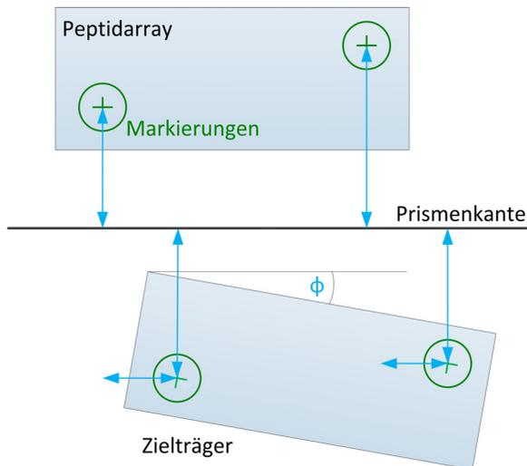
Abbildung 5.13 Positionierung zweier Oberflächen mit dem Prismen-Ansatz. Über das Knife-Edge-Prisma lassen sich mit der Kamera beide Oberflächen gleichzeitig betrachten. Für die Positionierung wird der Zielträger verfahren, bis der vertikale und horizontale Abstand der Markierungen und der Winkel zur Prismenkante mit denen des Peptidarrays übereinstimmen.
