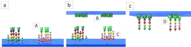
Abbildung 5.1 Wirkprinzip des In-situ-Transfers. a) Vollständig synthetisierte Peptide werden mit einer Thiolgruppe funktionalisiert (A). b) Alle Peptide werden vom Träger (C) abgespalten und diffundieren zum funktionalisierten Zielträger (B). c) Ausschließlich vollständige Peptide (D) werden auf dem Zielträger immobilisiert.
