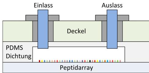
Abbildung 6.2 Schematische Darstellung der Flusszelle für Peptidmicroarrays
