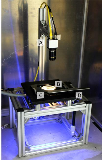
Abbildung 4.2 Prüfstand zur Klassifizierung der hergestellten Partikelschichten Die Kamera (A) nimmt die Partikelschicht (B) auf, die auf einer homogenen Beleuchtung (C) mit einem x,y-Tisch (D) positioniert wird.
