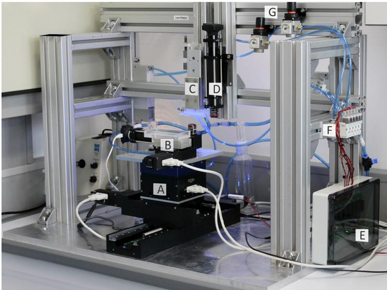
Abbildung 5.12 Maschine 2 zur Positionierung und Abformung von Peptidarrays. Mit der 4-Achs-Verfahreinheit (A) wird der Zielträger, eingespannt in den Vakuumhalter mit Wanne (B), gegenüber dem Peptidarray ausgerichtet, der auf der pneumatischen Linearachse (C) montiert ist. Mit dem eingebauten Mikroskop (D) können die Proben begutachtet werden. Die Automatisierung erfolgt mit LabVIEW über eine Motor- und Relaiskarte (E), die einen Ventilblock (F) ansteuert.
