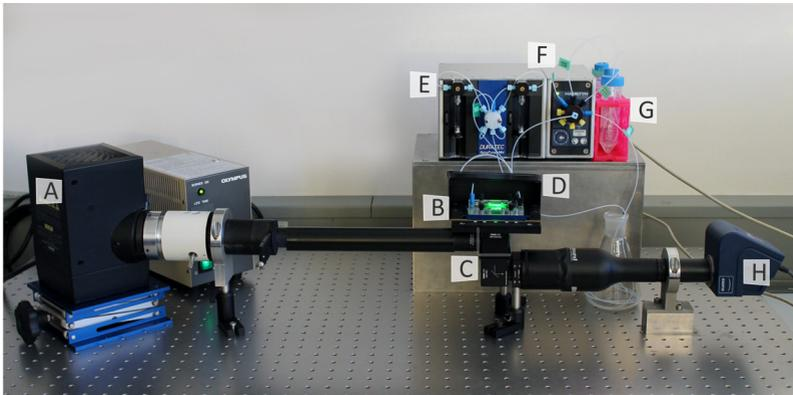
Abbildung 6.3 Komponenten der mikrofluidischen Inkubationskammer. Eine Weißlicht-Quecksilberdampfampe (A) beleuchtet den Mikrokanal (B). Das Licht wird über ein Fluoreszenzfilterset (C) gefiltert. Das Eintreten von Streulicht wird durch eine Abdeckung (D) verhindert. Über eine Spritzenpumpe (E) und ein Verteilerventil (F) wird der Array mit verschiedenen Medien (G) inkubiert. Das reflektierte Signal wird von einer Kamera mit Objektiv (H) detektiert.
