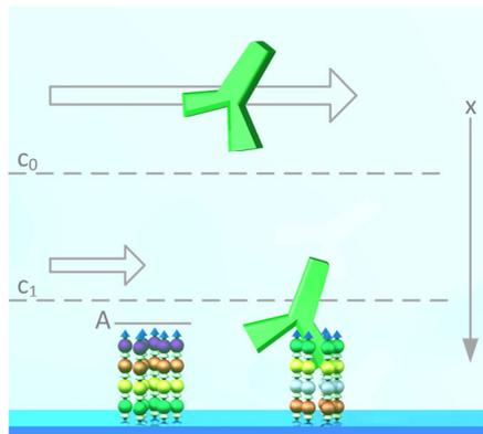
Abbildung 6.1 Bindung von Antikörpern an ein Peptidmicroarray. Der Prozess lässt sich in die Diffusion zur Oberfläche und einen anschließenden Bindungsmechanismus unterteilen.  $c_0$  kennzeichnet die Konzentration des Antikörpers in der Lösung,  $c_1$  die Konzentration an der Oberfläche und  $A$  die Fläche des Spots des Peptidmicroarrays.
