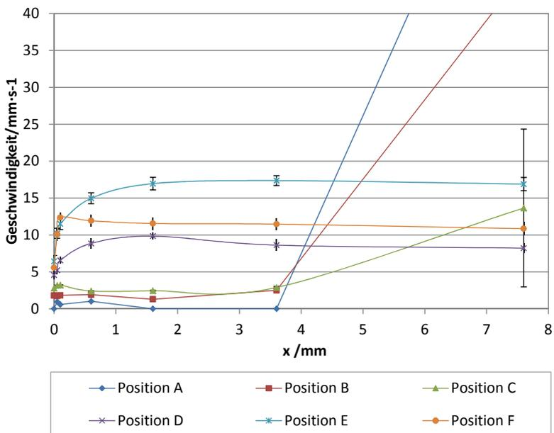
Abbildung 6.8 Geschwindigkeitsverteilung über die halbe Kanalbreite an den Stellen A – F entsprechend Abbildung 6.7a Die hohen Geschwindigkeiten an der Position A, B sind durch die Reduzierung des Strömungsquerschnitts am Auslass bedingt.
