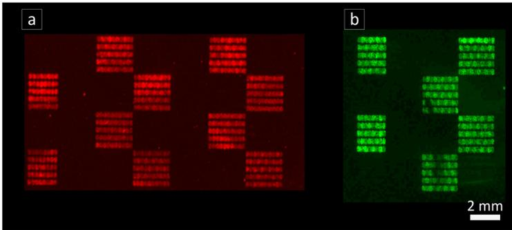
Abbildung 5.21 Übertrag eines kompletten Peptidarrays:a) auf einen starren Träger, b) auf eine COP Folie [55].
