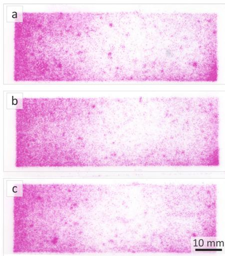
Abbildung 5.18 Verteilung der Anpresskraft für Maschine 2. Ein vollflächiger Kontakt mit ausreichend homogener Druckverteilung wurde erreicht.
