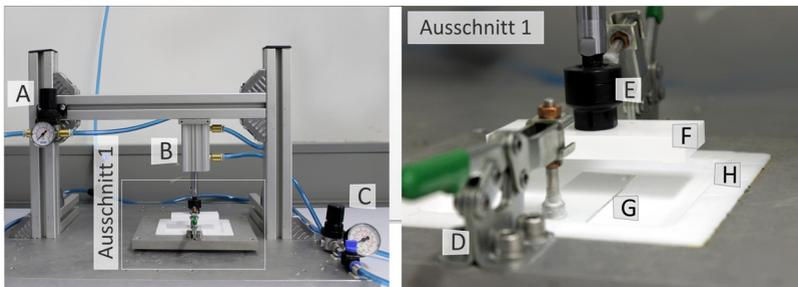
Abbildung 5.9 Peptidarrayabformanlage Maschine 1 Mittels Manometer (A) und 3/2-Wege-Handventil (C) lässt sich der Druck für den Pneumatik-Zylinder (B), der den Peptidmicroarray (F) und die Zieloberfläche (G) über ein Kugelgelenk (E) zusammenpresst und entformt, regeln. Die Waagerechtspanner (D) halten die Zieloberfläche beim Entformen. Der Übertrag findet in PBS-Puffer in einer Wanne (H) statt.
