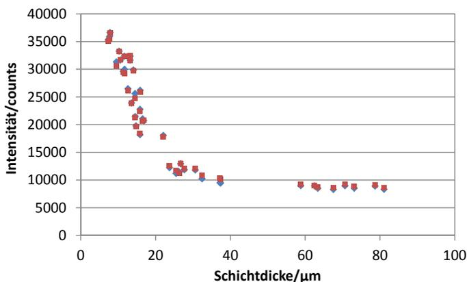
Abbildung 4.3 Verhältnis der Schicht und der Intensität.
