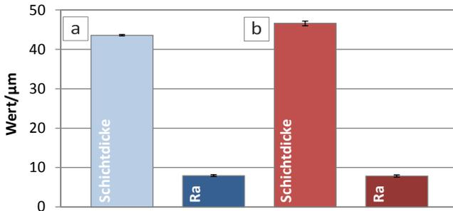
Abbildung 3.18 Mehrfaches Vermessen der Schicht zur Bestimmung der Homogenität. a) Mehrfaches Vermessen an der gleichen Stelle. b) Mehrfaches Messen unterschiedliche Stellen der gleichen Schicht.
