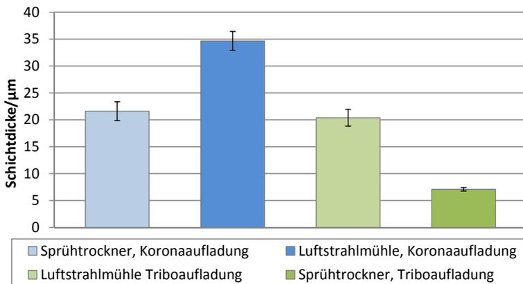
Abbildung 3.21 Vergleich der Abscheideraten für unterschiedliche Kombinationen von Partikeln und Aufladungsmechanismen. Beschichtungsparameter entsprechend B.2 (nach [31]).
