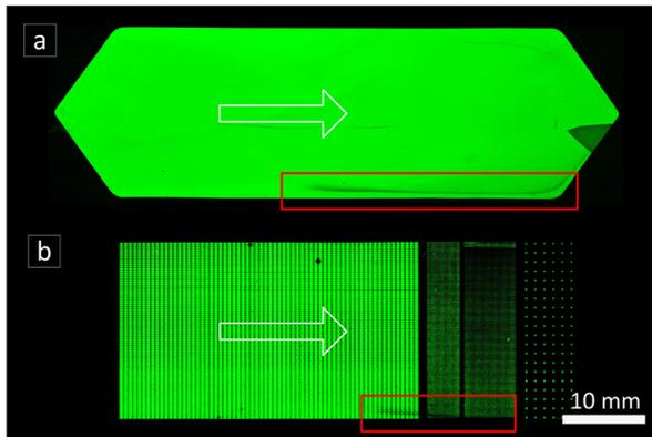
Abbildung 6.16 Auswirkung der Strömungsunterschiede auf das Inkubationsergebnis. a) bei einem Biotinarray, b) bei einer Biotin-Oberfläche. Aufgrund der Strömungsgeschwindigkeitsverteilung sind die rot markierten Abschnitte diffusionsbeschränkt.
