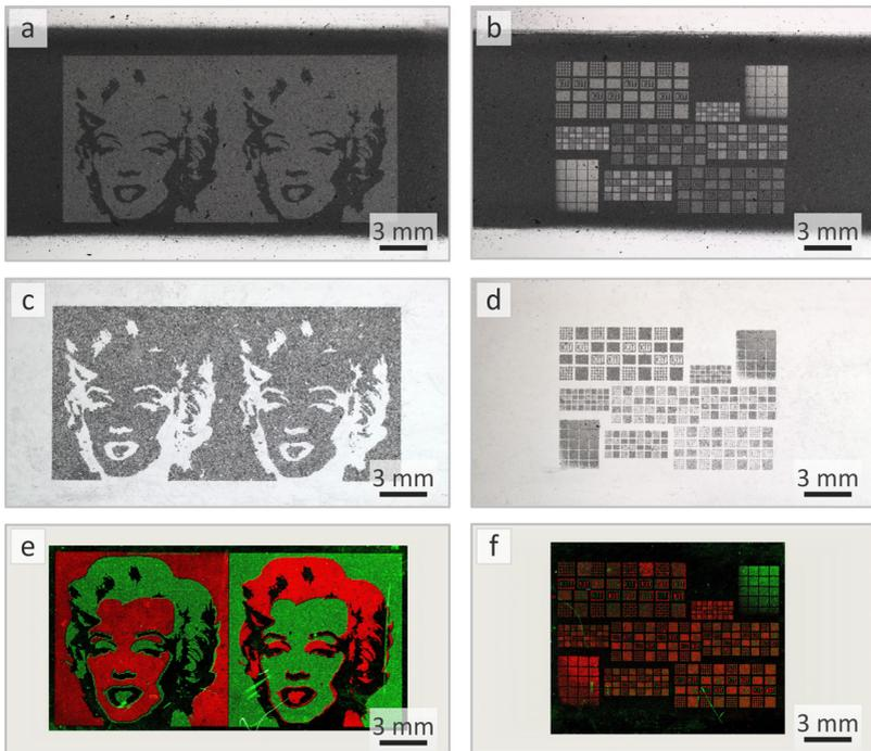
Abbildung 3.24 Dipeptidsynthese für zwei Arrays a), c), e) zeigen das Werk „Marilyn Monroe“ (1967) von Andy Warhol mit 80.000 Spots auf einer Fläche von 16 mm × 32 mm. b), d), f) zeigen die Auflösung der Methode durch eine Variation des Pitches von 100 µm bis 33 µm. Dabei zeigen a), b) die mit dem Laser strukturierte Partikelschicht, c), d) die angeschmolzenen Partikel nach der Reinigung und e), f) den Fluoreszenznachweis der Kupplungsreaktion.
