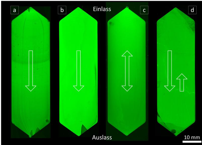
Abbildung 6.12: Mit fluoreszenzmarkiertem Streptavidin inkubierte flächige Biotin-Oberflächen a) und b) wurden symmetrisch inkubiert mit unterschiedlicher Flussrate. c) wurde symmetrisch inkubiert. d) wurde asymmetrisch alternierend inkubiert bei gleicher Inkubationszeit (nach [82]).
