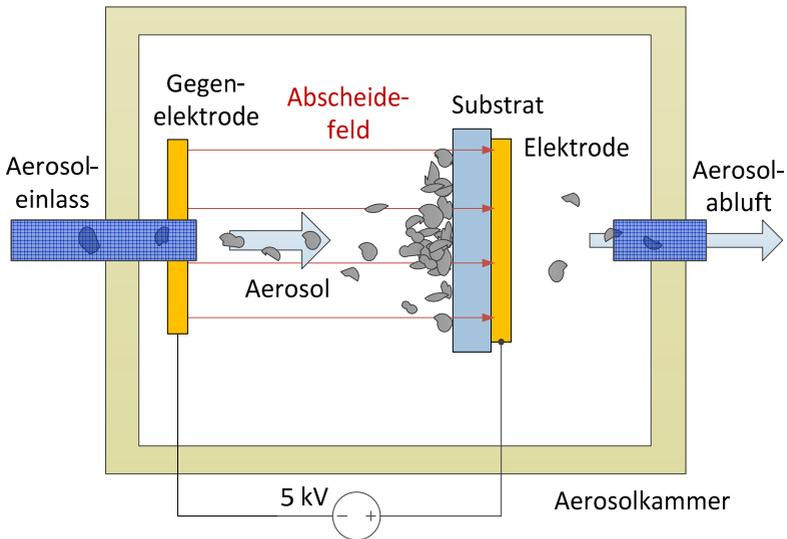
Abbildung 3.5 Konzept der elektrostatischen Aerosolabscheidung. Die geladenen Partikel im Aerosol werden auf das Substrat durch ein homogenes elektrisches Feld beschleunigt und lagern sich dort ab. Die Aerosolabluft wird aus der Beschichtungskammer gepumpt.
