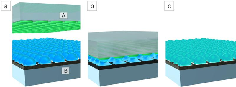
Abbildung 5.2 Positionsgesteuerter Übertrag auf einen Tropfenarray. a) Der Molekülarray (A) wird über dem Dropletmicroarray (B) lateral positioniert. b) Der Array wird vertikal verfahren, bis ein Transfer der Moleküle in die Tropfen stattfindet. c) Der Molekülarray wird planparallel entfernt.
