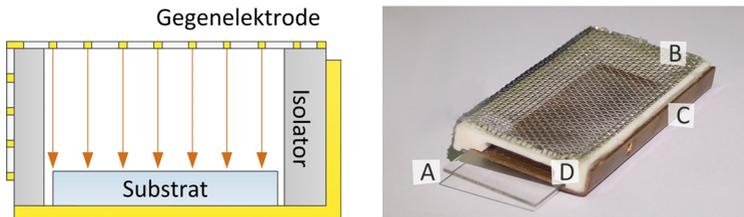
Abbildung 3.11 Prototyp des Rahmens. Das Substrat(A) kann zwischen die Gitterelektrode (B) und die Abscheideelektrode (C) in einen Rahmen aus Polyamid (D) eingespannt werden.
