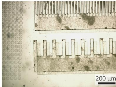
Abbildung 5.20 Mikroskopaufnahme von Mustern zweier übereinander positionierter Objektträger zur Bestimmung des Positionier-Messabweichung.
