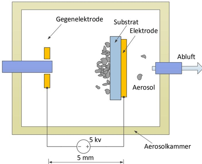
Abbildung B.1 Aufbau zur triboelektrischen Aufladung der Partikel
