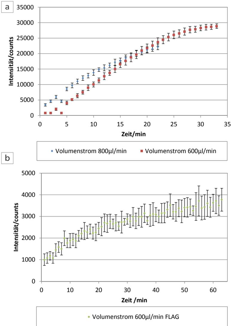
Abbildung 6.15 Aufnahme eines Bindungsprozesses a) von Streptavidin auf einer Biotin-Oberfläche. b) der fluoreszenzmarkierte Antikörper bindet an das FLAG-Peptid des Peptidarrays.
