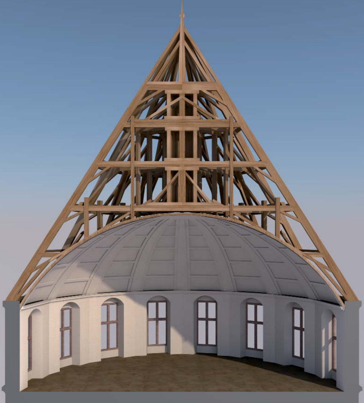
Abb. 23: Saal- und Dachstuhlrekonstruktion nach der Zeichnung des Wetzlarer Skizzenbuches, Grafik: Julian Hanschke.
