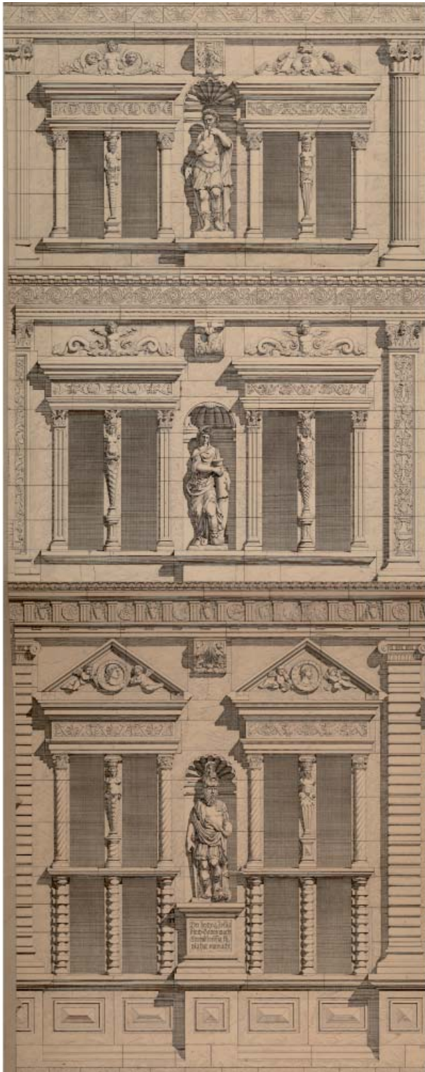
Abb. 51: Fassadenausschnitt des Ottheinrichsbaus nach der Bauaufnahme von Koch/Seitz 1891 mit Überlagerung einzelner Bauformen nach Serlio. Wesentliche Teile des Fassadendekors wurden nach den um 1550 vorliegenden Musterbüchern und Architekturtraktaten wohl unter Mitwirkung des Bauherrn gestaltet.
