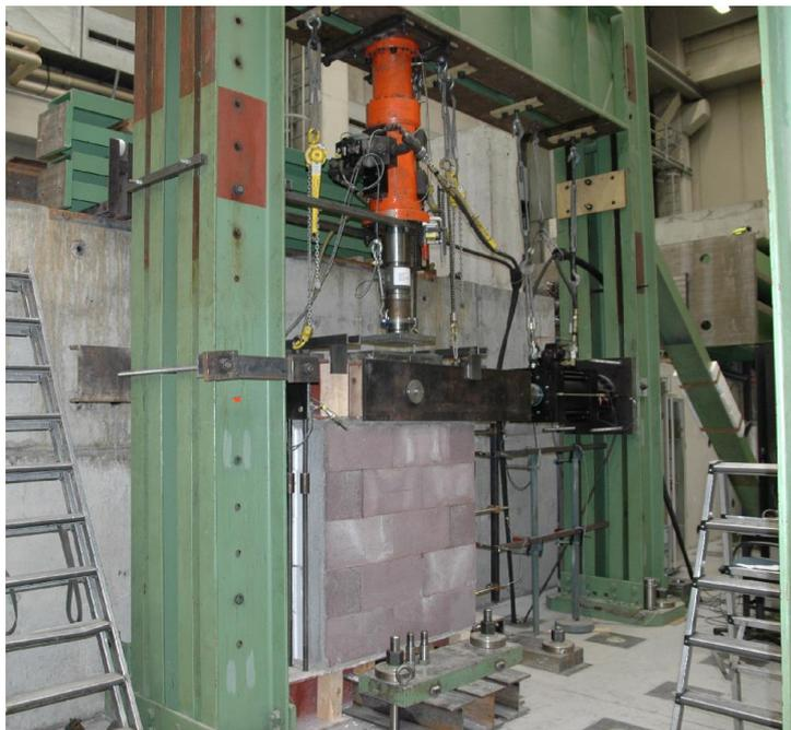
**Abb. 4-27** Versuchsstand der kleinformigen Wandversuche
