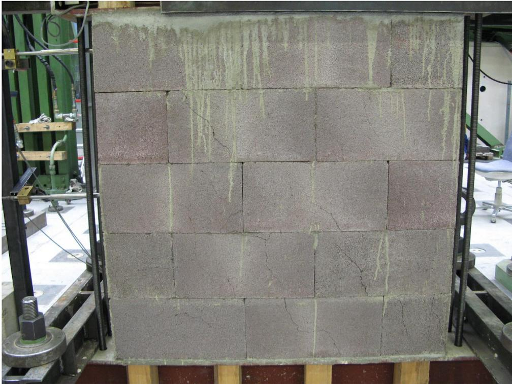
**Abb. 4-41** Um seitliche Abspannungen erweiterter Versuchsaufbau
