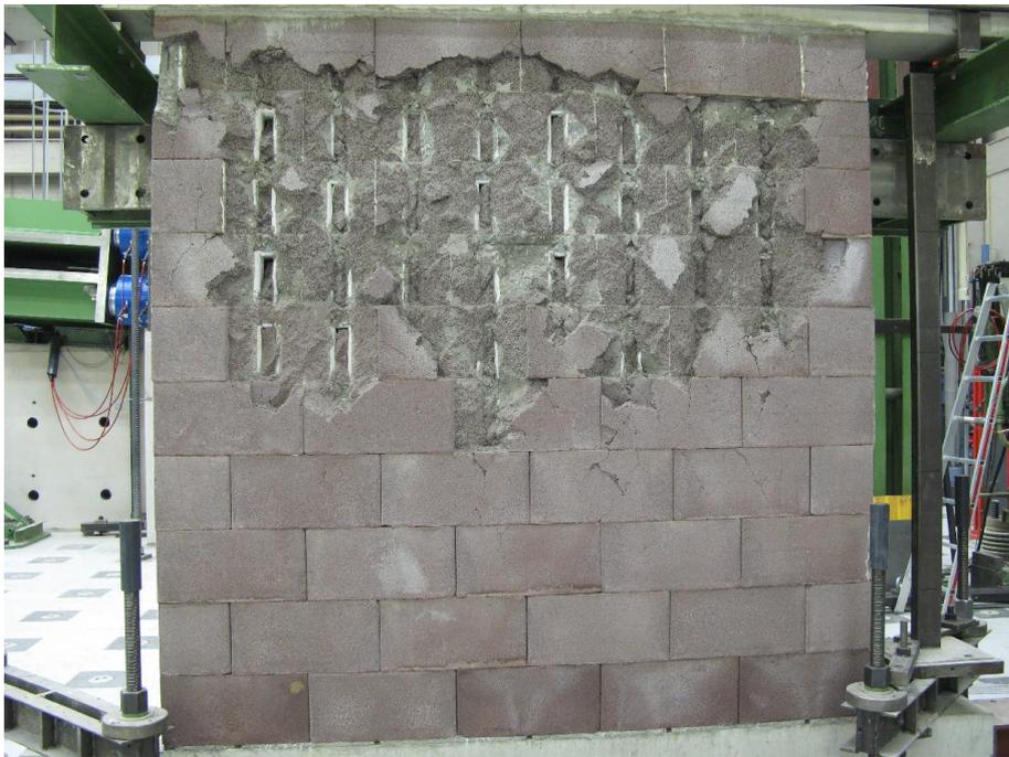
**Abb. 4-23** Schädigung der Leichtbetonaußenschale
