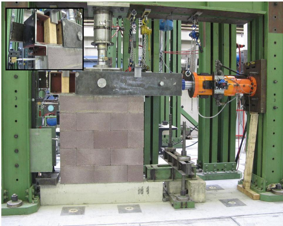
**Abb. 4-37** Modifikation im Versuchsaufbau für Wandversuch 10 (a und b)
