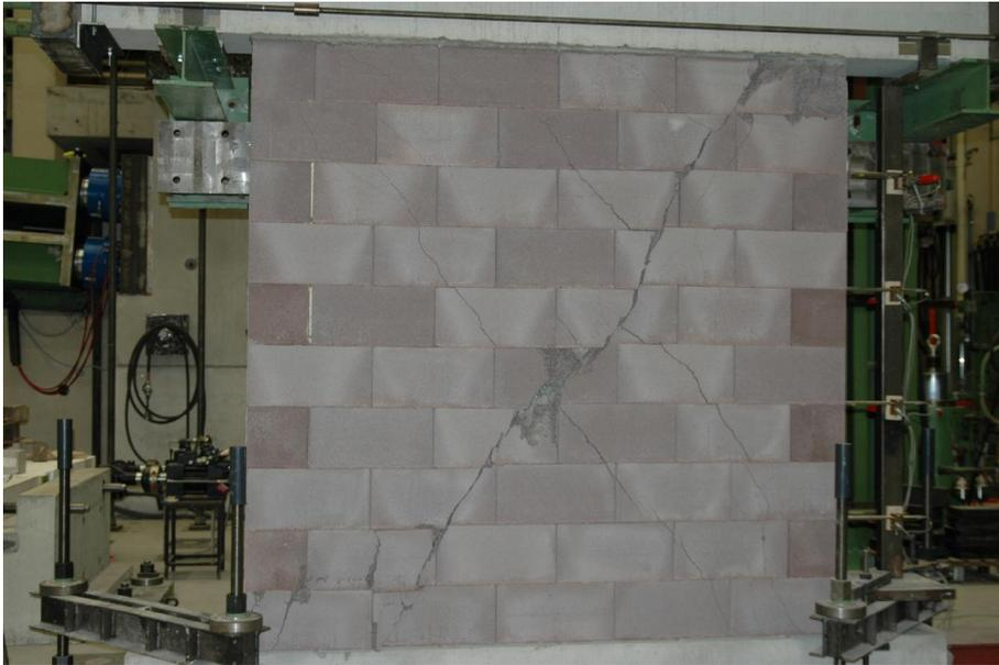
**Abb. 4-12** Trennriss bei Wand 2
