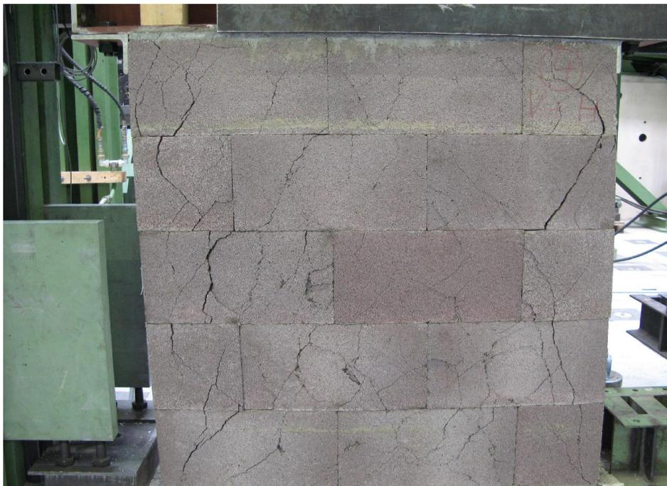
**Abb. 4-40** Rissbild am Ende von Wandversuch 10b
