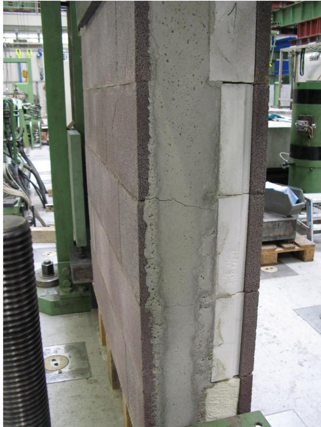
**Abb. 4-32** Ausknicken der Randstützen
