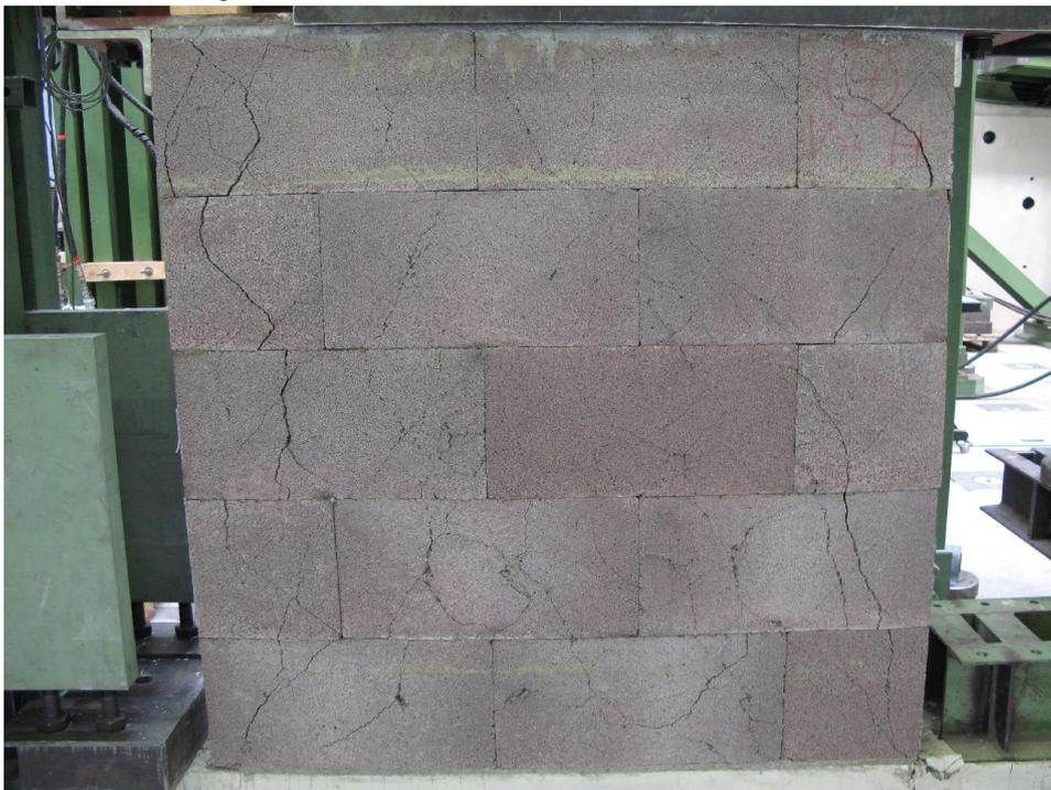
**Abb. 6-14** Rissbild am Ende von Wandversuch 10a
