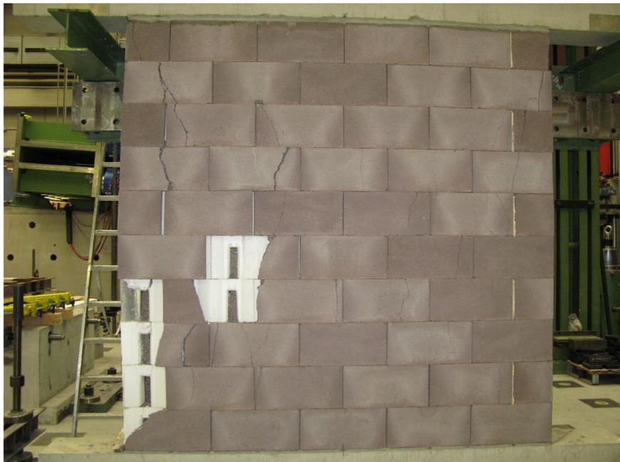
Abb. 4-16 Wandversuch 3 nach Versuchsende
