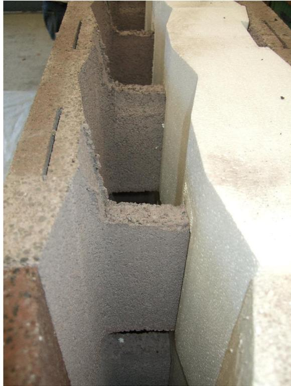
**Abb. 4-10** Entfernung der Polystyrol-Stegummantelung
