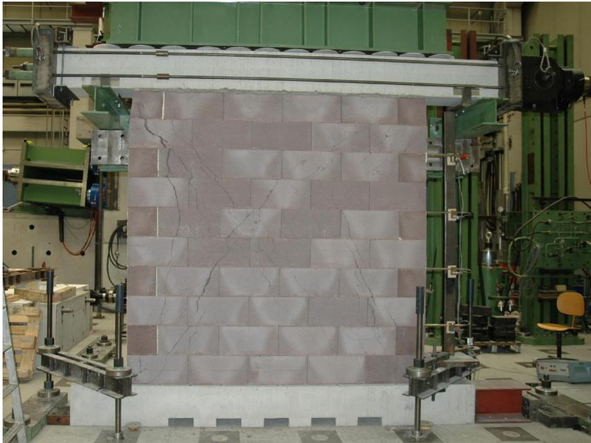
**Abb. 4-9** Rissbild von Wand 1 nach Versuchsende
