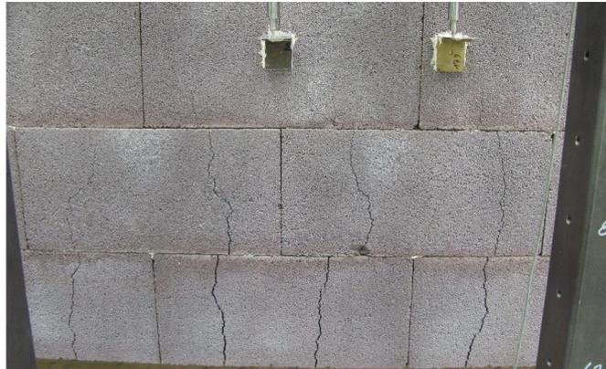
**Abb. 6-17** Biegerisse im mittleren Drittel des Balkens
