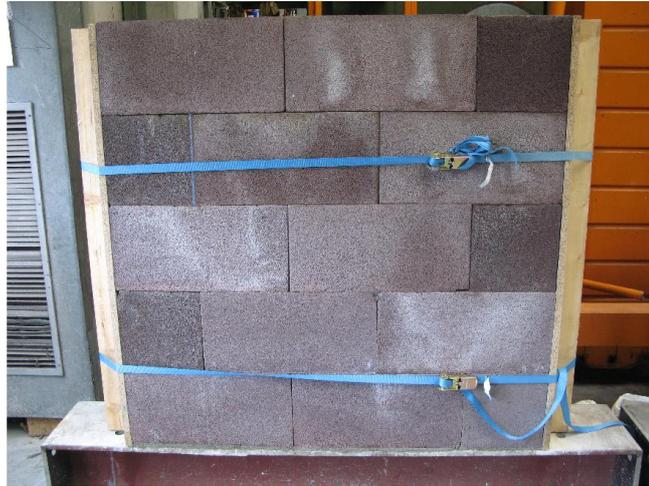
Abb. 4-24 Herstellung der kleinformatischen Wandversuche
