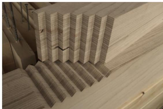
Abb. 3 Ergebnis Abbund eines Treppenversatzes
