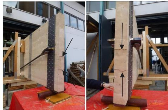
Abb. 34 Schubversagen beim verstärkten Hauptträger
