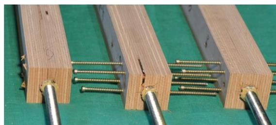
**Abb. 14** Versagensformen der maßgebenden Verbindungen der Versuchsreihe mit Querlagen und mit Querbewehrung
