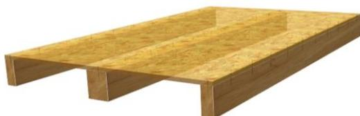
Abb. 6 Einseitig beplankte, mechanisch befestigtes Element
