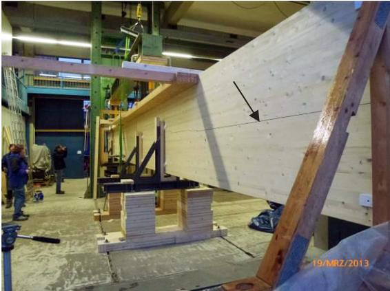
Abb. 33 Schubversagen im unverstärkten Hauptträger
