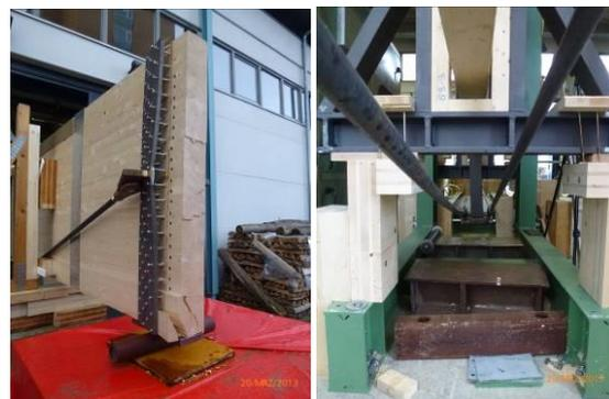
Abb. 35 Versagen an der Stahlplatte und seitliches Ausweichen der Spreizpfosten
