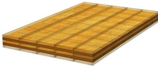
Abb. 10 Brettsperrholzelement
