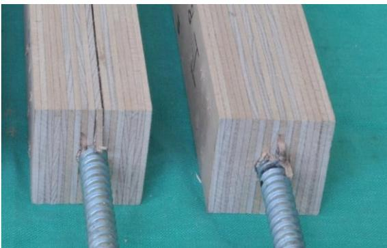
Abb. 11 Reihe 3: Versagensformen der maßgebenden Verbindung
