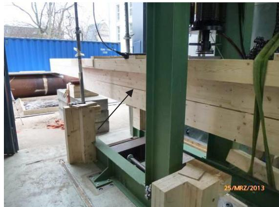
Abb. 36 Schubversagen beim unverstärkten Nebenträger
