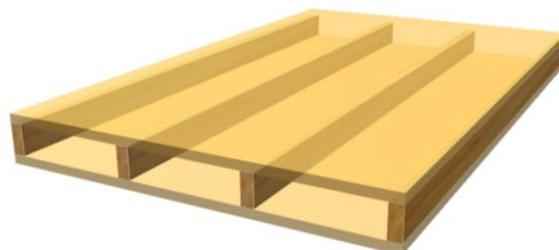
Abb. 7 Schubfest verklebtes Kastenelement
