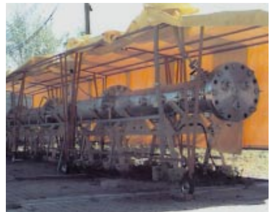
Abb. 4: Das FZK-Rohr zur Untersuchung der Ausbreitung von Detonationswellen.
