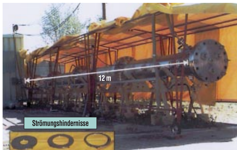
Abb. 6: FZK-Versuchsanlage zur Untersuchung von turbulenten Strömungs- und Verbrennungsprozessen. Zur Turbulenzerzeugung können ringförmige Strömungshindernisse mit unterschiedlichem Versperungsgrad ( BR = 30 \dots 90 \% ) im Rohr eingebaut werden.
