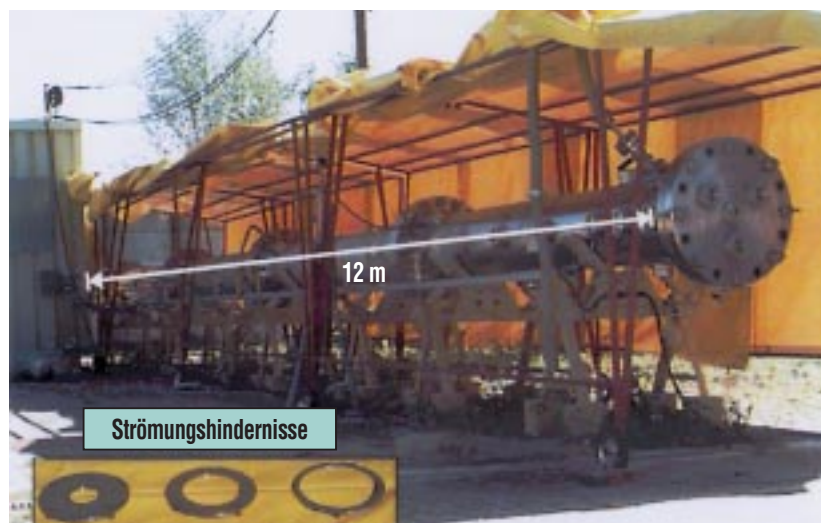
Abb. 6: FZK-Versuchsanlage zur Untersuchung von turbulenten Strömungs- und Verbrennungsprozessen. Zur Turbulenzerzeugung können ringförmige Strömungshindernisse mit unterschiedlichem Versperungsgrad (BR = 30 ... 90 %) im Rohr eingebaut werden.
