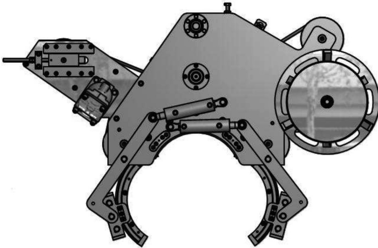
Abb. 4.6.: Schwenkeinheit mit Rohrklammer (Mitte unten) und Fräseinrichtung (rechts)
