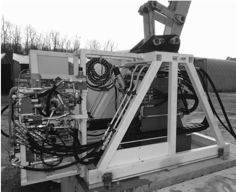
Abb. 4.2.: Anbaugerät zur definierten Abtragung von Stahlbeton
