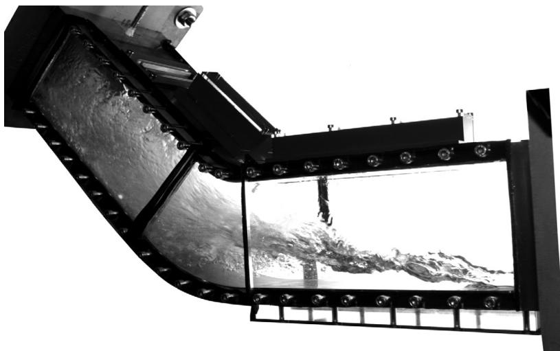
Abbildung 3-7 Momentaufnahme bei teilweise umgekehrter Strömung
