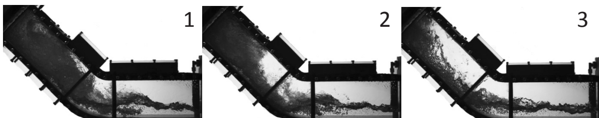
Abbildung 4-7 Teilweise umgekehrte Strömung im Knickkanal
