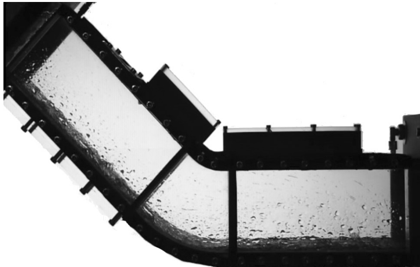
Abbildung 4-2 Schießende Strömung mit Tropfenabriss im Knickkanal
