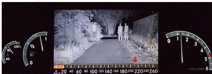
Abbildung 3.3: Armaturenbrett des Versuchsfahrzeugs mit aktivem Nachtsichtsystem
