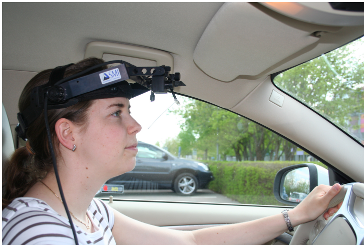
Abbildung 4.1: Proband mit einem Helm-basierenden Eye-Tracking System
